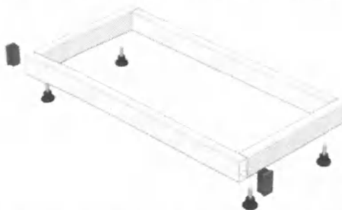
Рис.2-Сборка каркаса: ЛК-400 ШРП-Я-1Н, ЛК-400 ШРП-Я-2Н, ЛК-600 ШРП-Я-1Н, ЛК-600 ШРП-Я-2Н, ЛК-800 ШРП-Я-1Н, ЛК-800 ШРП-Я-2Н
