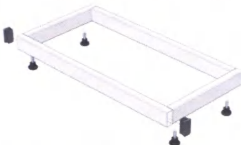
Рис.2-Сборка каркаса: ЛК-400 ШЛП-Я-1Н-С, ЛК-400 ШЛП-Я-2Н-С, ЛК-600 ШЛП-Я-1Н-С, ЛК-600 ШЛП-Я-2Н-С, ЛК-800 ШЛП-Я-1Н-С, ЛК-800 ШЛП-Я-2Н-С, ЛК-400 ШЛП-Я-1Н-Л, ЛК-400 ШЛП-Я-2Н-Л, ЛК-600 ШЛП-Я-1Н-Л, ЛК-600 ШЛП-Я-2Н-Л, ЛК-800 ШЛП-Я-1Н-Л, ЛК-800 ШЛП-Я-2Н-Л
