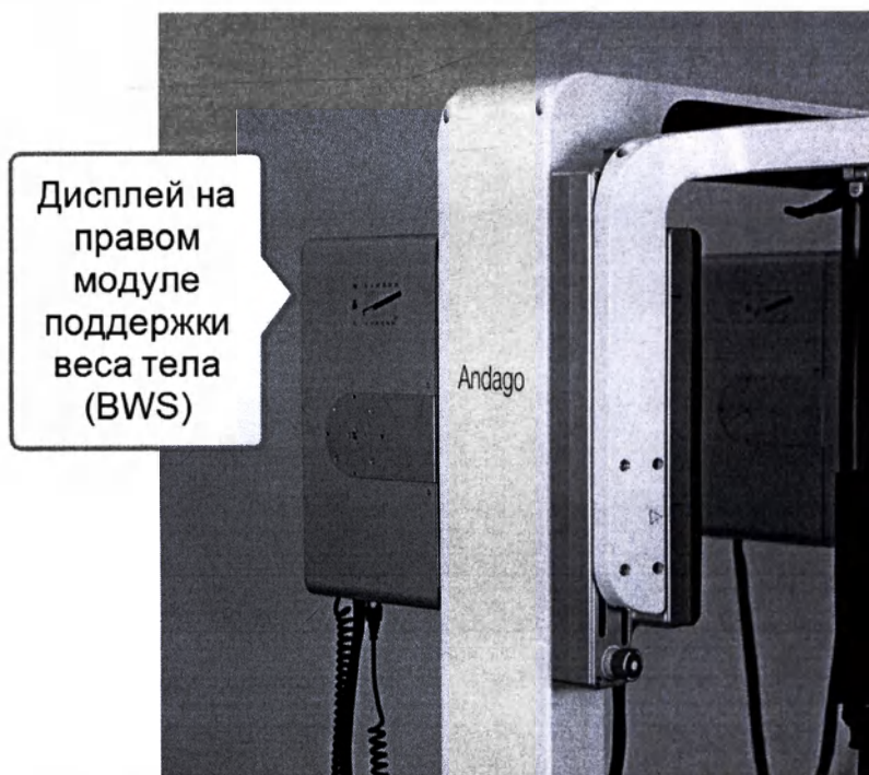
Рисунок 3–20: Дисплей находится на задней стороне правого модуля поддержки веса тела
