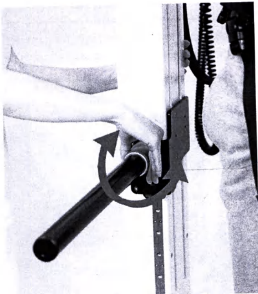
Рисунок 3-14: Ослабление или затягивание фиксирующего кольца
