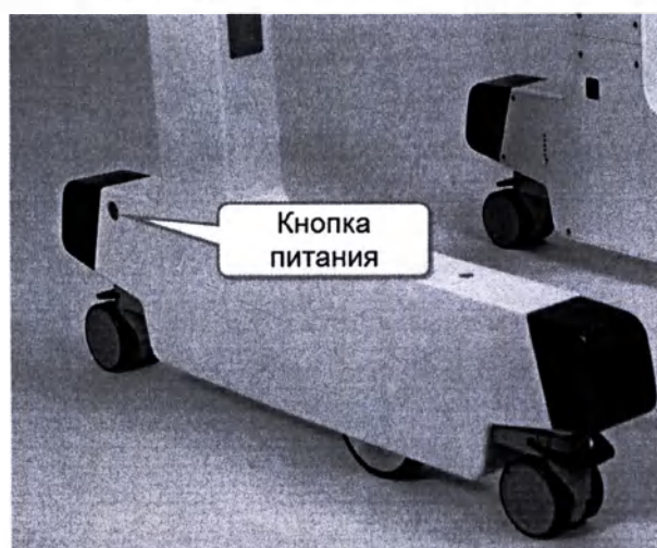
Рисунок 3–26: Выключите устройство Andago. Кнопка питания находится над правым задним колесом
