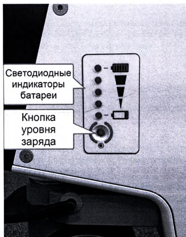
Рисунок 3–29: Проверка уровня заряда батареи. Индикатор находится над левым задним колесом
