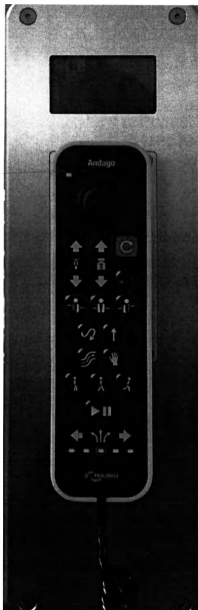
Рисунок 3–21: Дисплей с ручным пультом управления на задней крепежной панели
