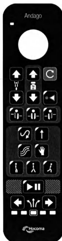
Рисунок 3–9: Ручной пульт управления устройством Andago
