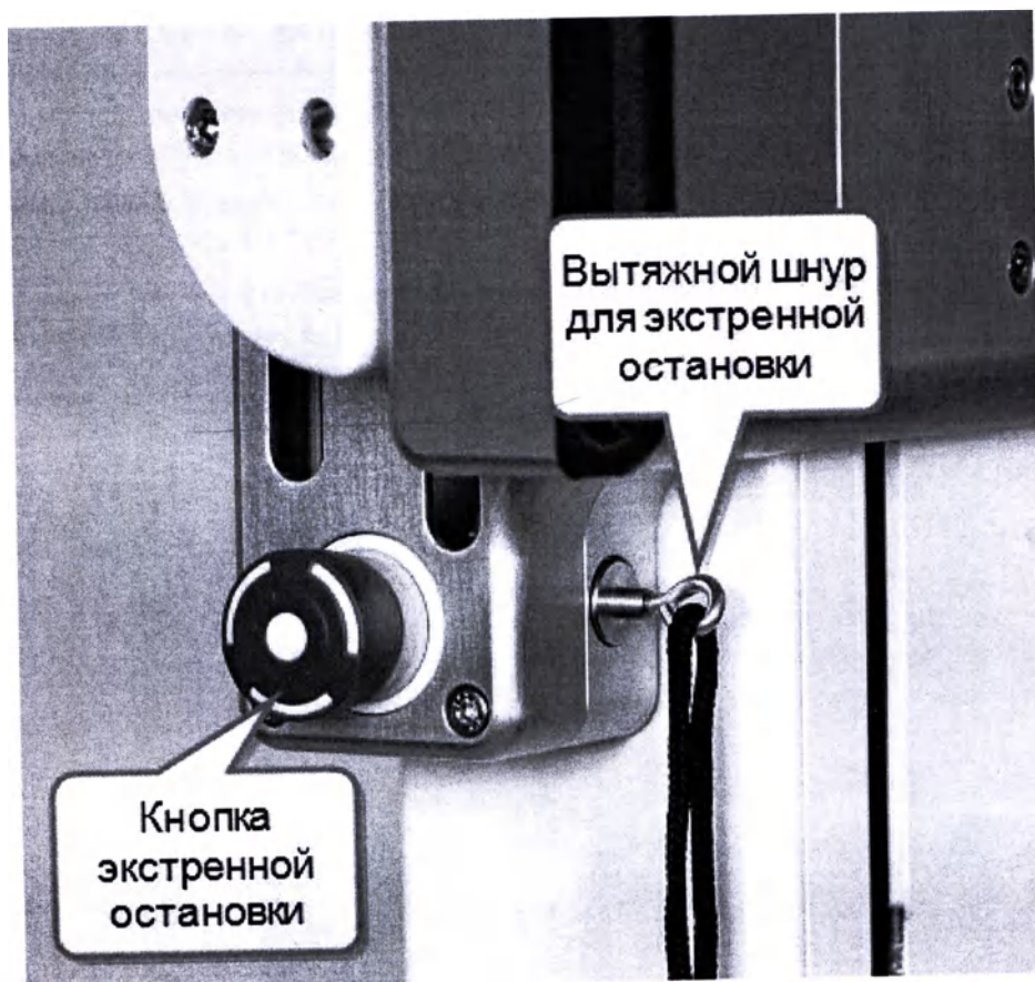
Рисунок 4–33: Два механизма остановки: красная кнопка экстренной остановки и магнитный вытяжной шнур для экстренной остановки
