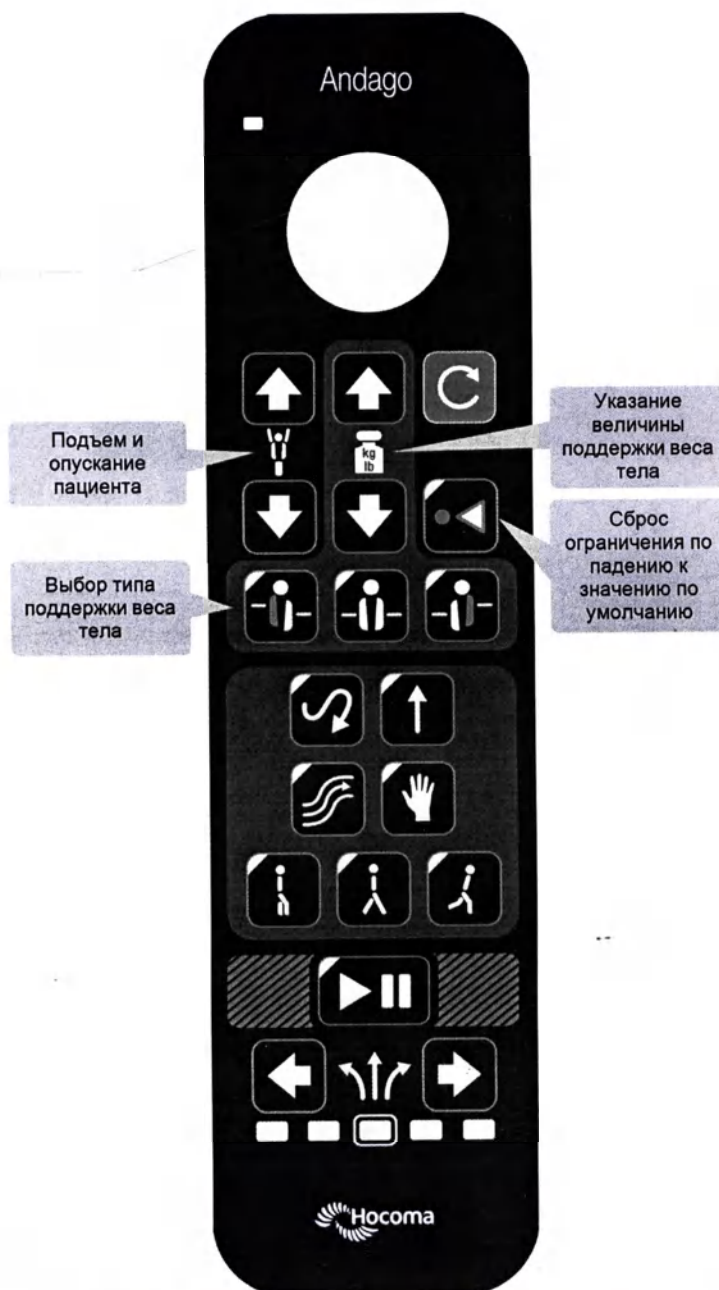
Рисунок 4–15: Функции пульта управления, используемые на этом этапе.
