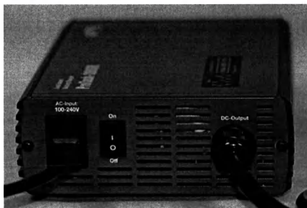
Рис. 3–27: Тумблер включения/отключения зарядного устройства Andago.
