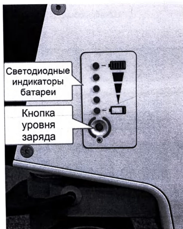
Рисунок 4–4: Проверка уровня заряда батареи. Индикатор находится над левым задним колесом
