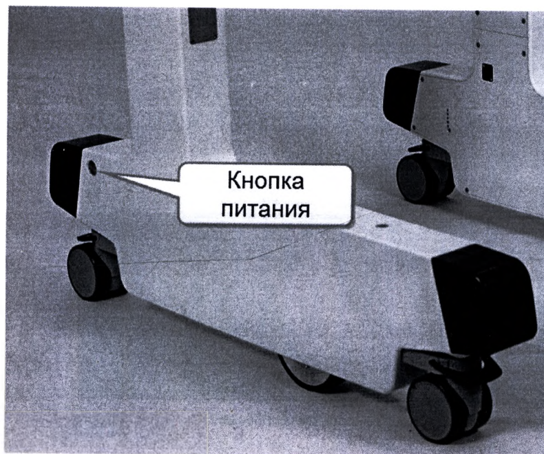
Рисунок 4-43: Выключите устройство Andago. Кнопка питания находится над правым задним колесом
