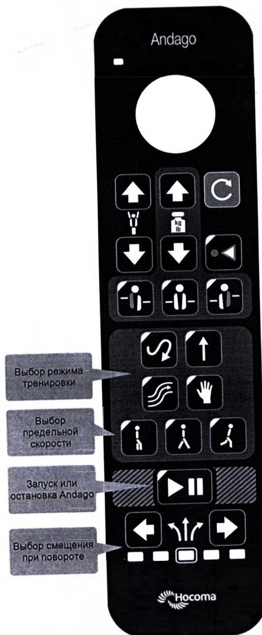
Рисунок 4–28: Функции пульта управления, используемые на этом этапе.
