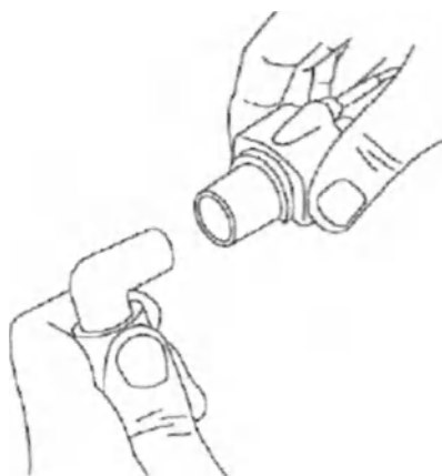
Рисунок 20-18. Подсоединение адаптера IRMA, изображение II
