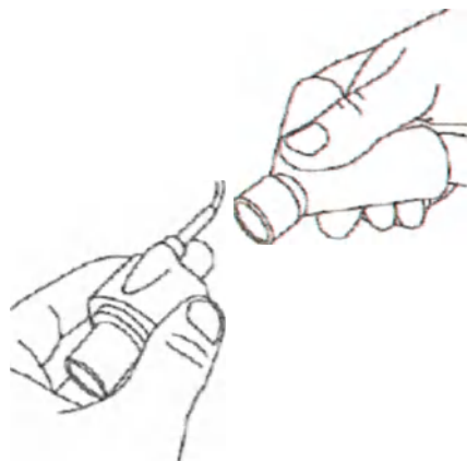
Рисунок 20-17. Подсоединение адаптера IRMA, изображение I
