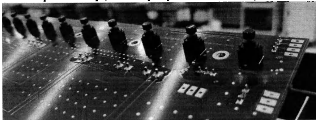
Рисунок 179. Ключевой переключатель на печатной плате 06-E01
