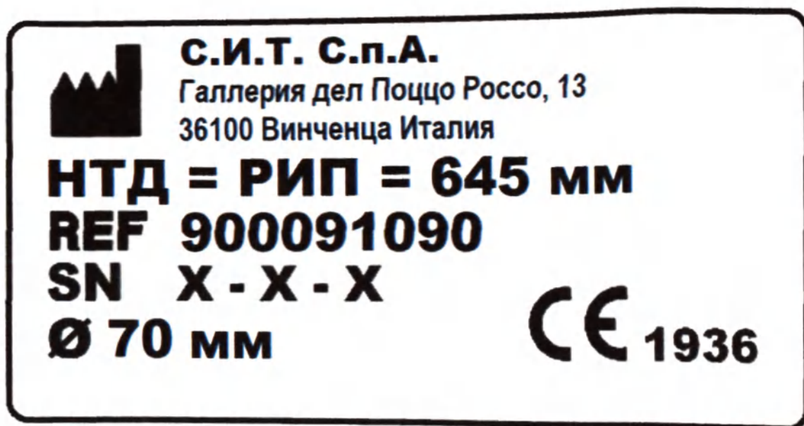
Верхняя часть аппликатора внутренний диаметр 70 мм, длина 170 мм. Маркировка на русском языке
