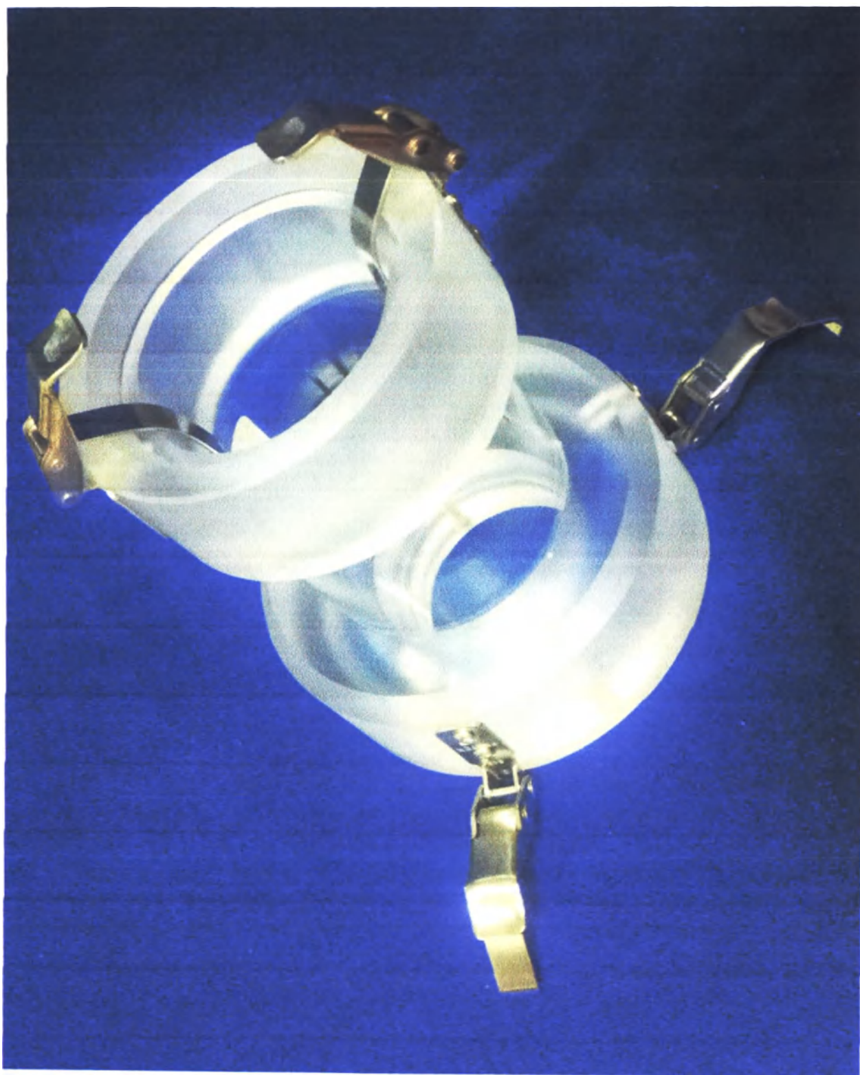
Верхняя часть аппликатора внутренний диаметр 70 мм, длина 170 мм
