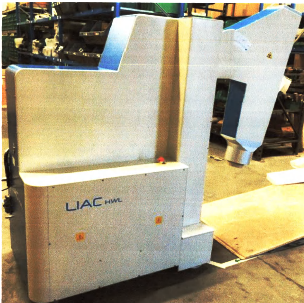
Блок мобильный 10 МэВ/12 МэВ (в сборе). Вид сбоку
