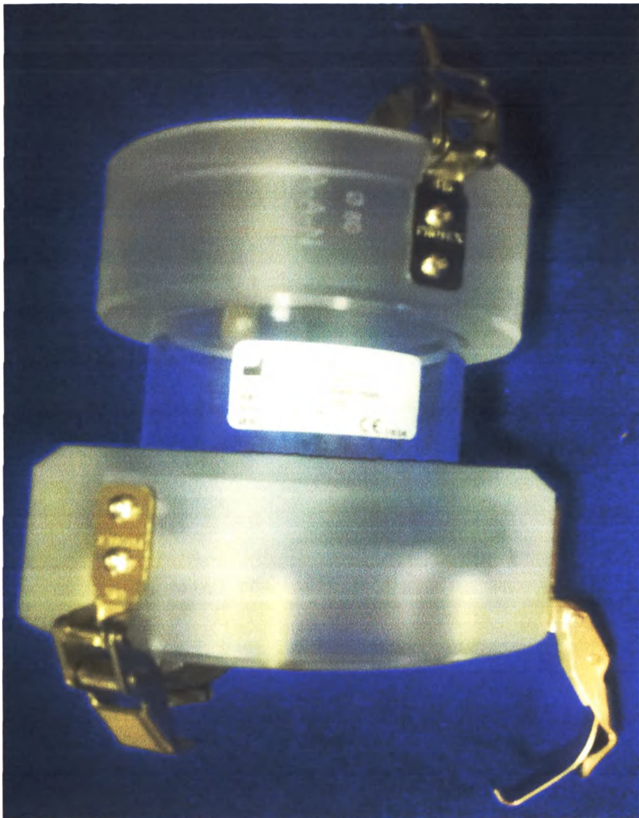
Верхняя часть аппликатора внутренний диаметр 80 мм, длина 90 мм
