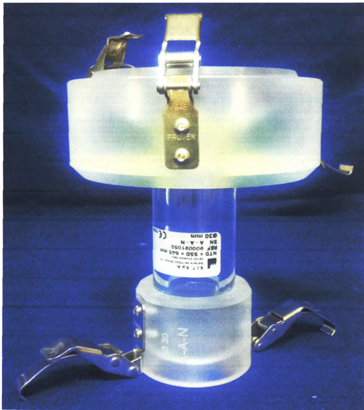
Верхняя часть аппликатора внутренний диаметр 30 мм, длина 170 мм
