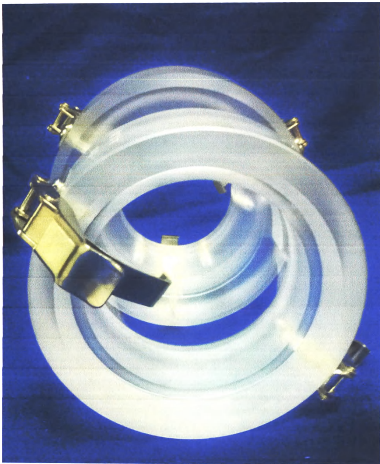
Верхняя часть аппликатора внутренний диаметр 90 мм, длина 170 мм
