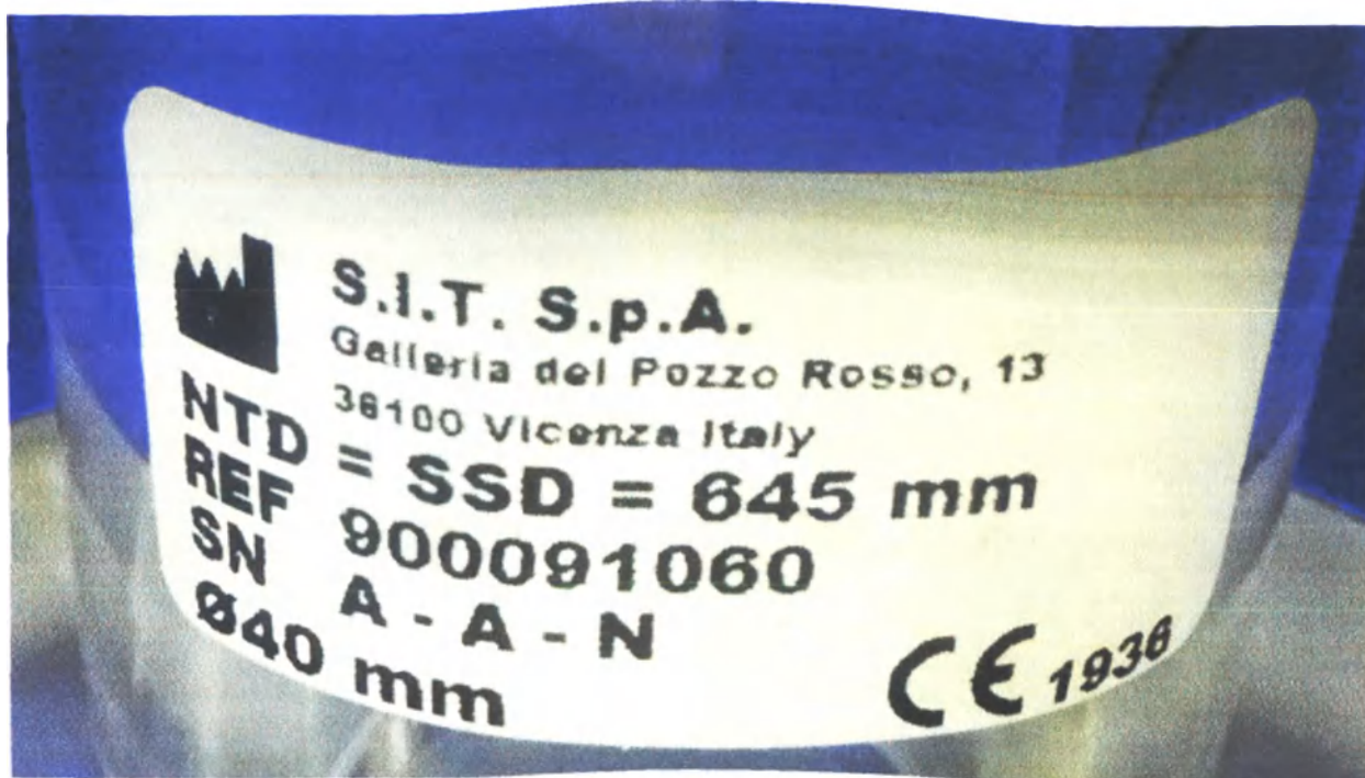
Верхняя часть аппликатора внутренний диаметр 40 мм, длина 170 мм. Маркировка
