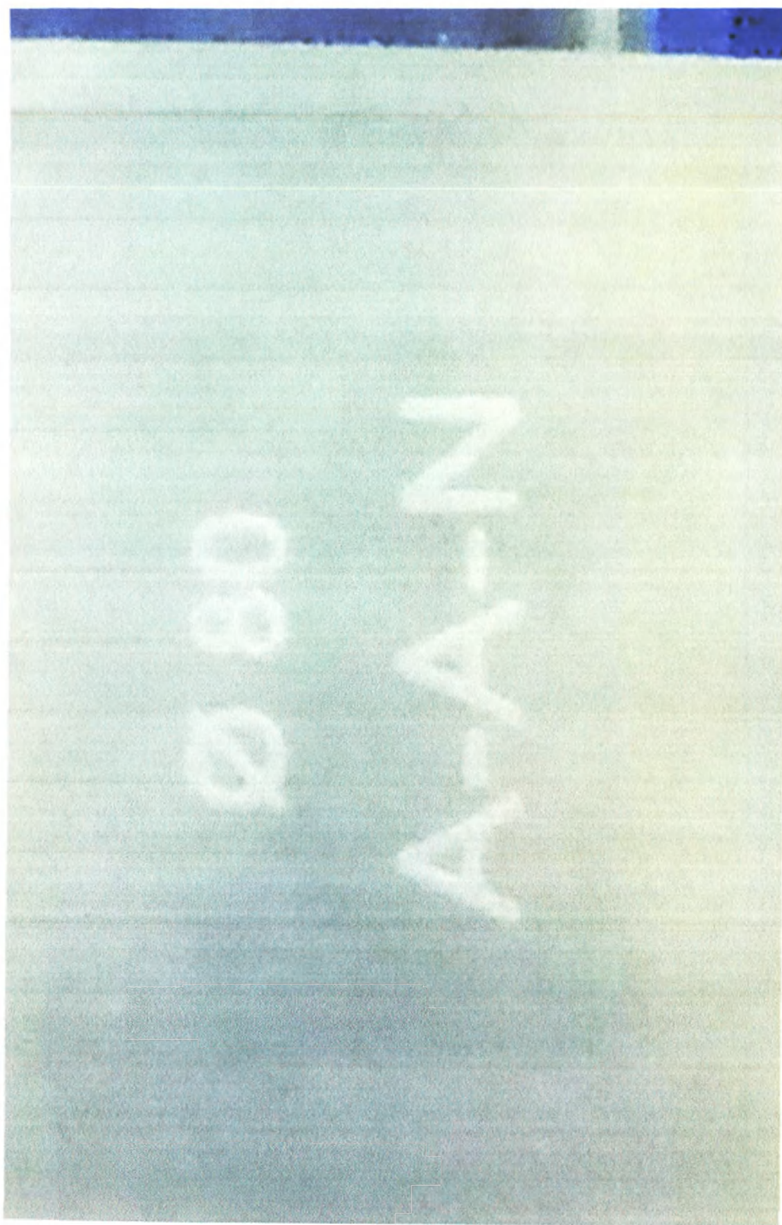
Верхняя часть аппликатора внутренний диаметр 80 мм, длина 170 мм. Маркировка
