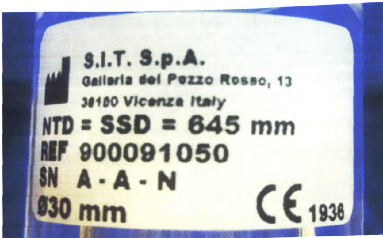
Верхняя часть аппликатора внутренний диаметр 30 мм, длина 170 мм. Маркировка
