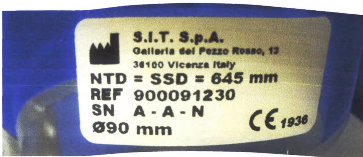
Верхняя часть аппликатора внутренний диаметр 90 мм, длина 90 мм. Маркировка
