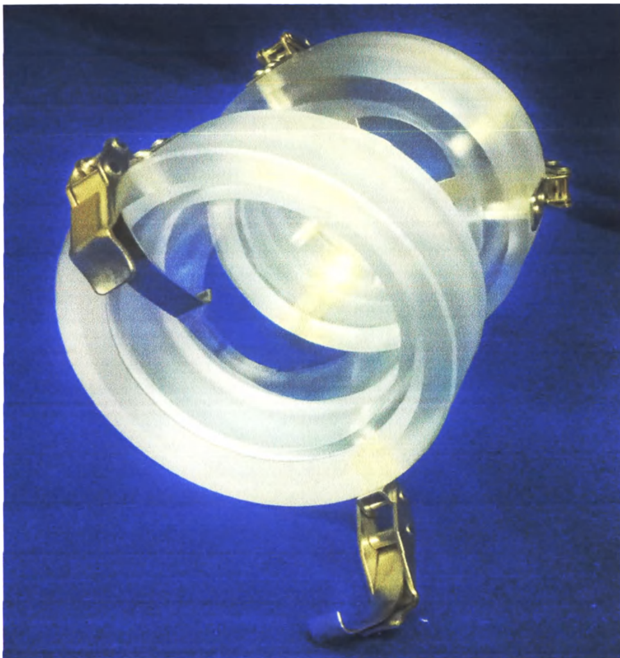
Верхняя часть аппликатора внутренний диаметр 100 мм, длина 90 мм
