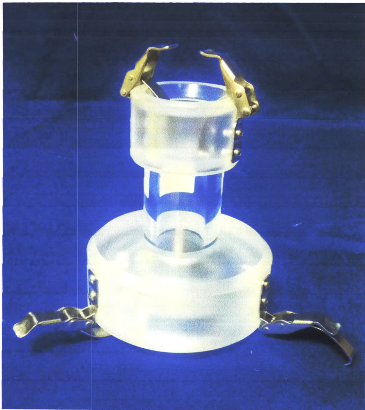
Верхняя часть аппликатора внутренний диаметр 40 мм, длина 170 мм
