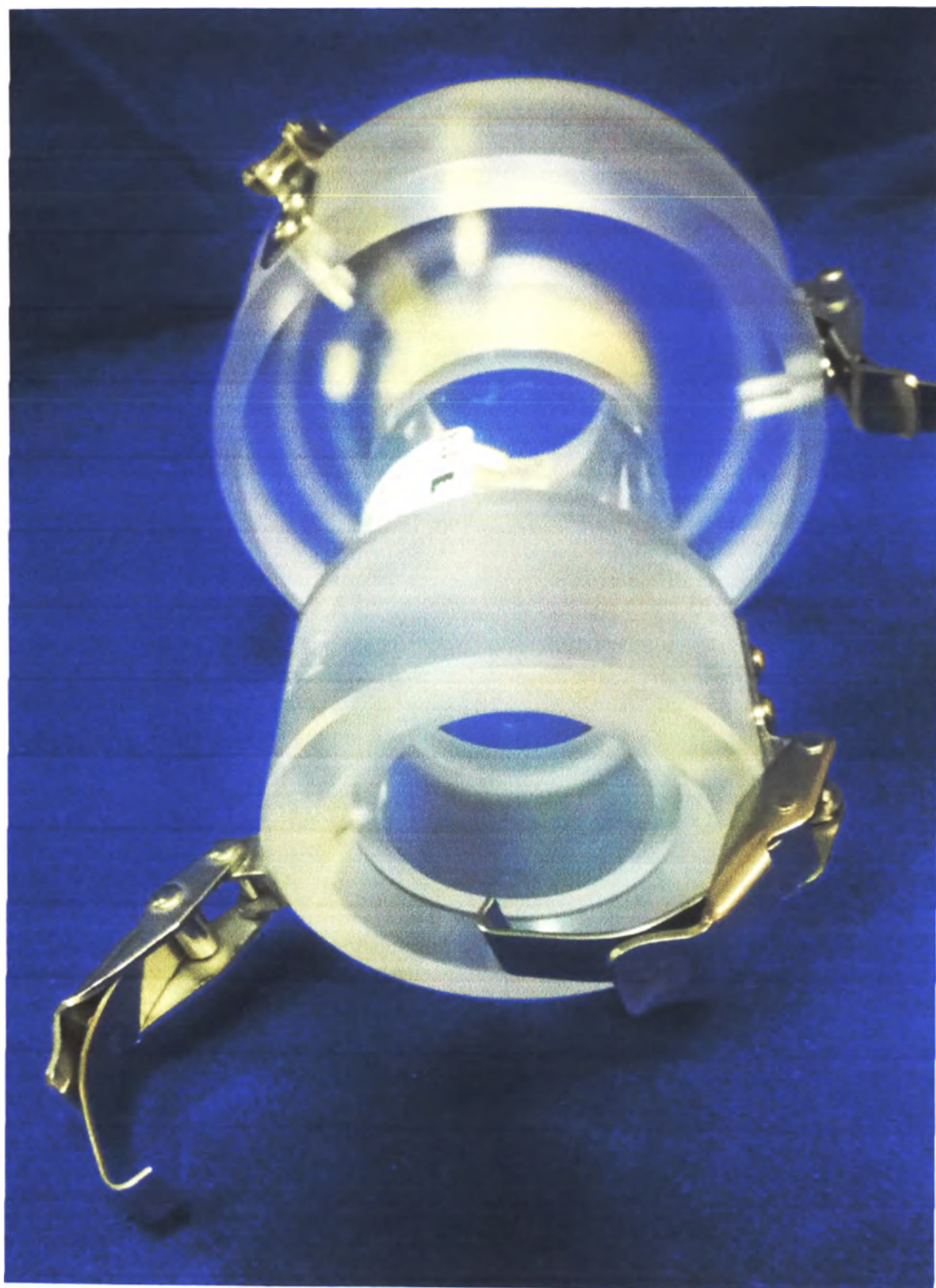
Верхняя часть аппликатора внутренний диаметр 50 мм, длина 170 мм
