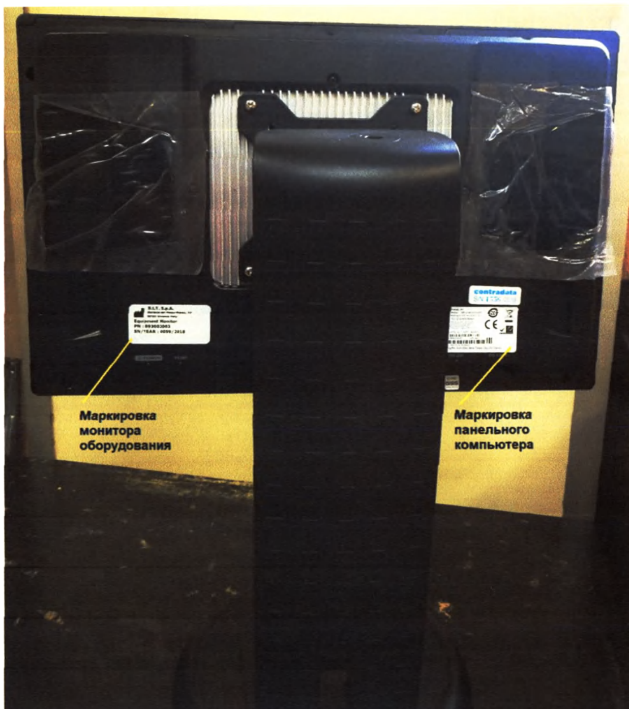
Монитор оборудования (в сборе, вид сзади) (Реальное оборудование может отличаться от показанного на рисунке)
