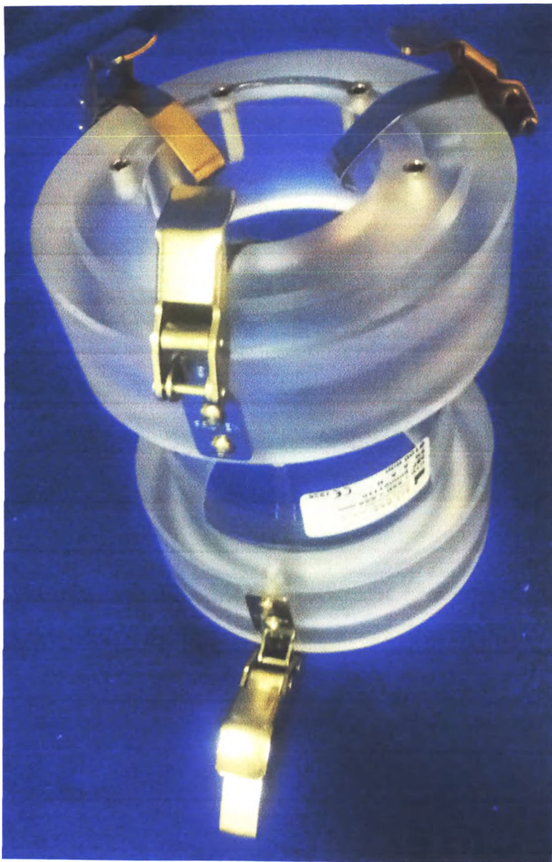
Верхняя часть аппликатора внутренний диаметр 100 мм, длина 170 мм
