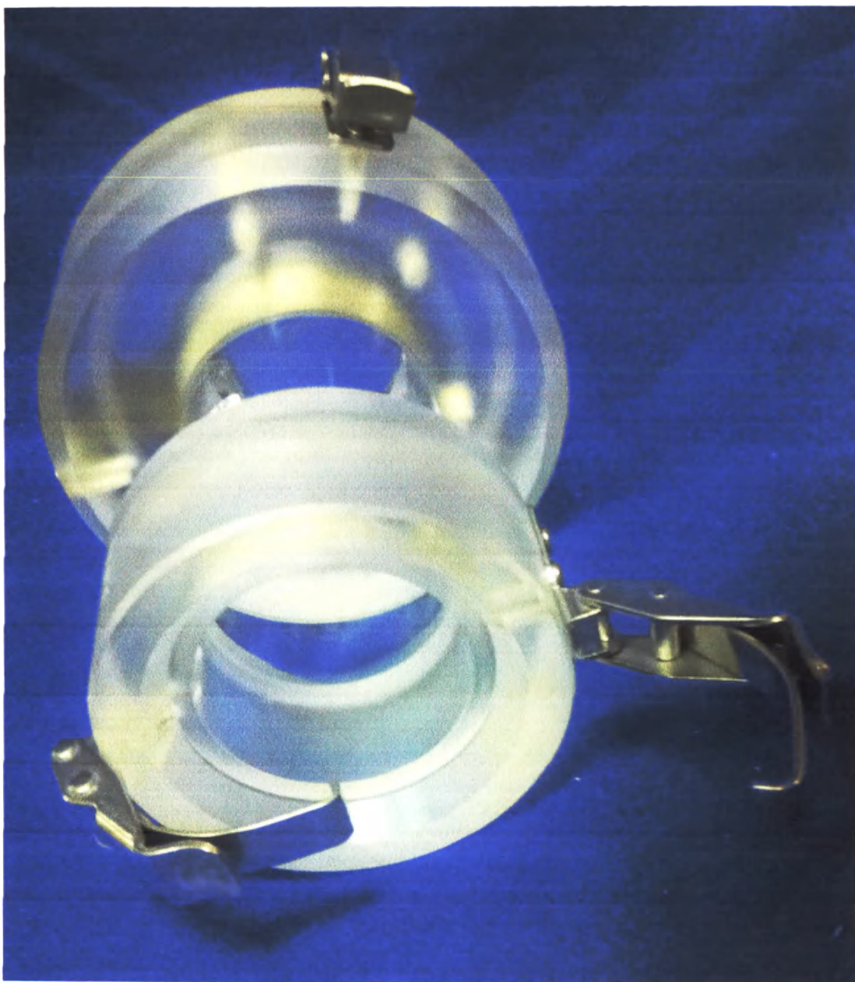
Верхняя часть аппликатора внутренний диаметр 60 мм, длина 170 мм
