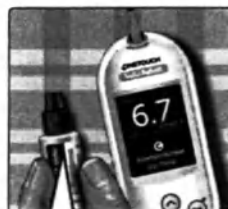
Пример диапазона Контрольный раствор средней концентрации OneTouch Verio®: диапазон контрольных значений 5,7–7,7* ммоль/л
