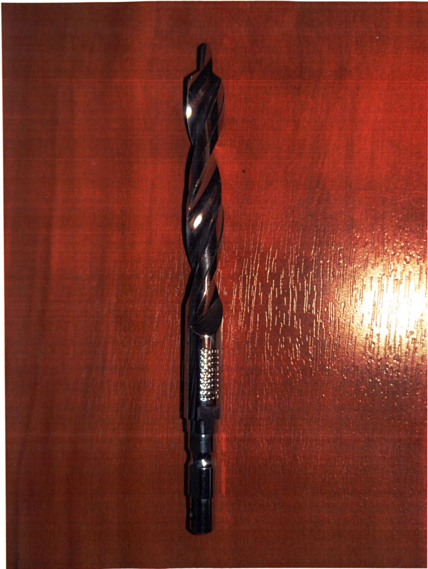
Сверло стартовое, диаметр 9,525 мм (14000200E)
