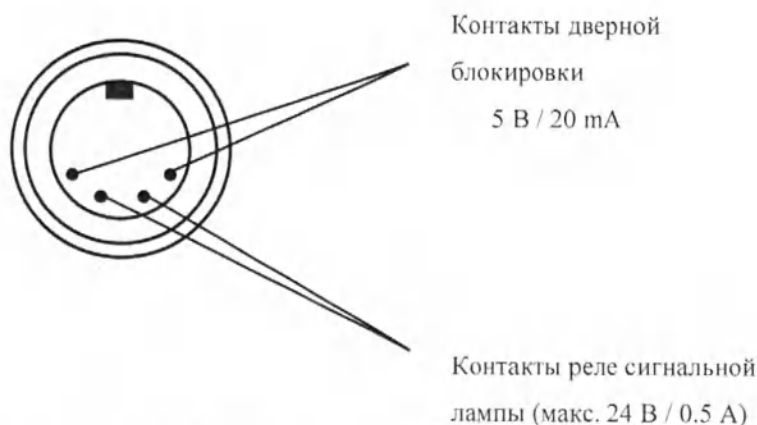
Рисунок 8: Схема подключения дверной блокировки и сигнальной лампы
