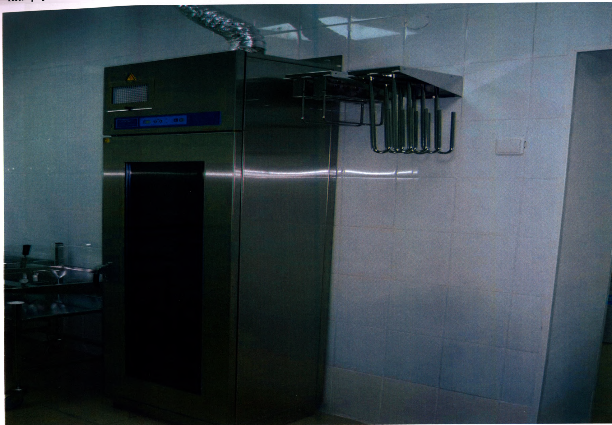
Шкаф сушильный В-3000 с принудительной циркуляцией воздуха.
