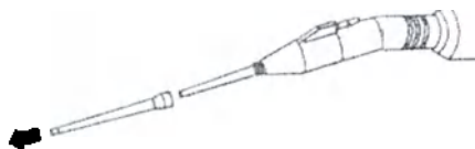
Рисунок 5 - Демонтаж крышки наконечника
