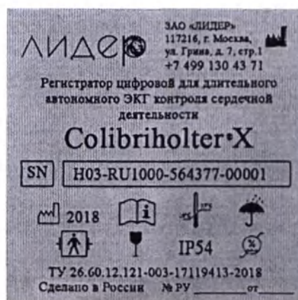
Рис. 3 - Маркировочная табличка регистратора
