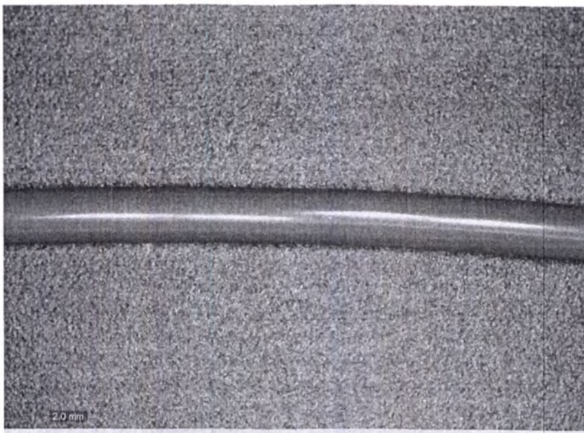
Рис.3. Увеличенное изображение средней части Катетера баллонного дилатационного РТА iVascular, вариант исполнения: OCEANUS 35.
