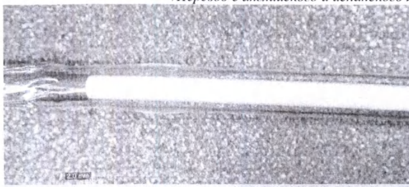
Рис.4. Увеличенное изображение части в месте соединения трубки с баллоном Катетера баллонного дилатационного PTA iVascular, вариант исполнения: OCEANUS 14 PRO.
