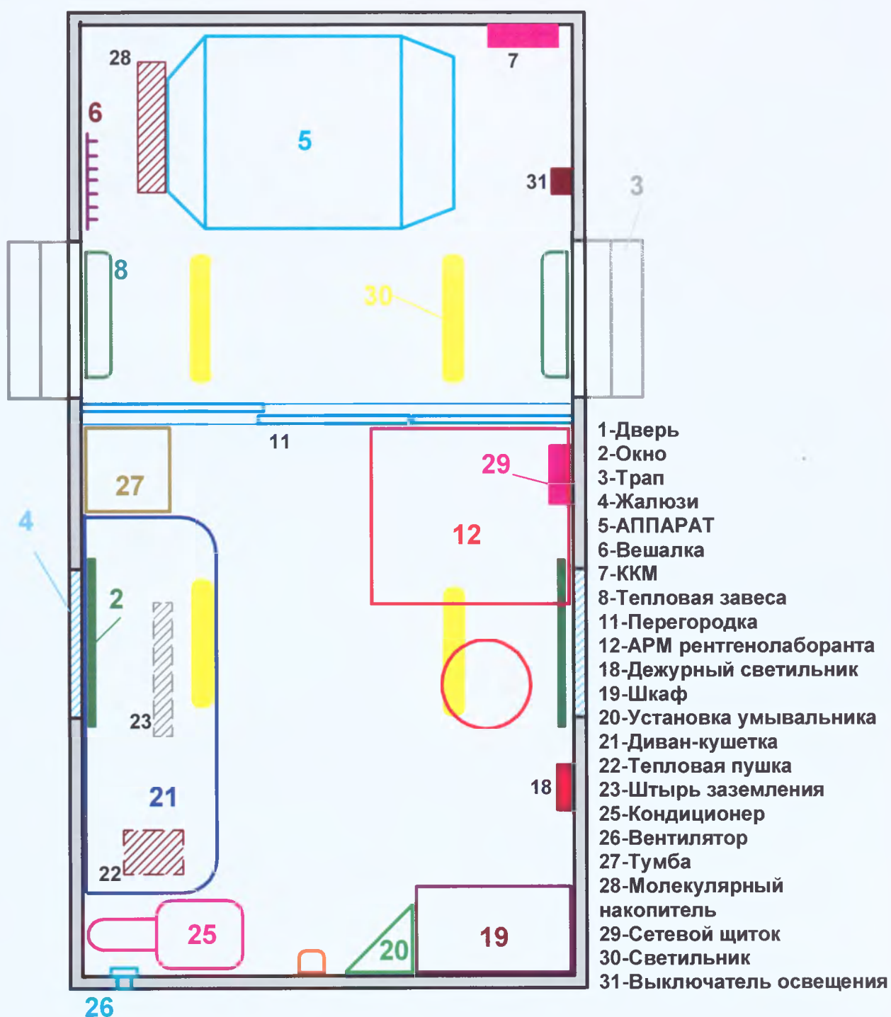
Рисунок 2 - Расположение оборудования в КАБИНЕТЕ
