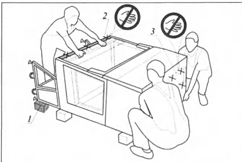
1 – подкладка-упор; 2 – блок УФ-облучения; 3 – заслонка выпускного проёма.
