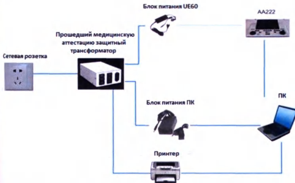
Рис. 2 Использование AA222 совместно с защитным трансформатором и проводным подключением к ПК.
