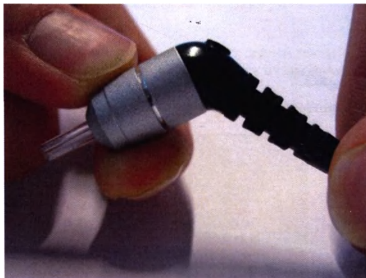
Рис. 27 Фиксатор наконечника пробника
