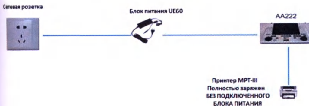
Рис. 3 Использование AA222 совместно с блоком питания и оптическим подключением к компьютеру.
