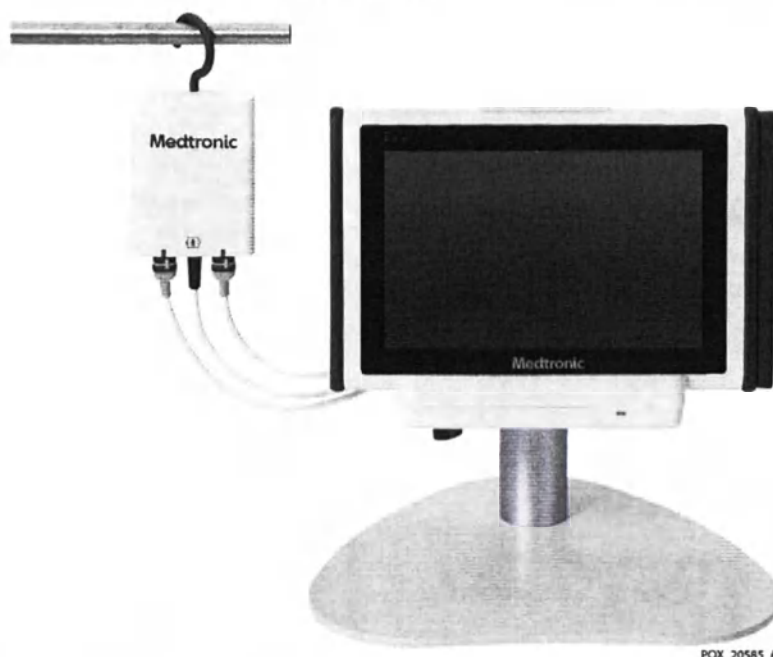
Рис. 3-13. Система мониторинга на стойке с закрепленным на поручне предварительным усилителем
