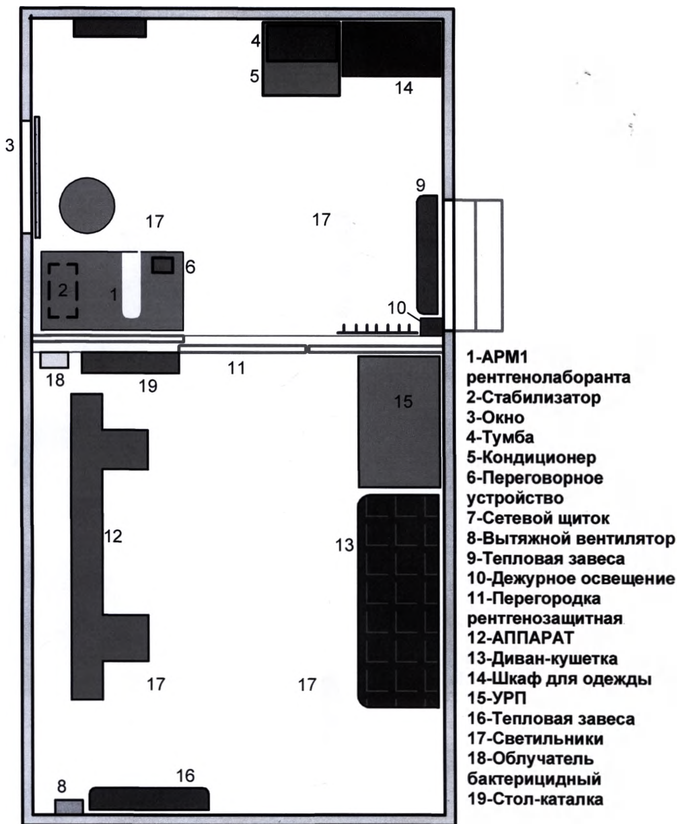
Рисунок 2 – Расположение оборудования в КАБИНЕТе*
