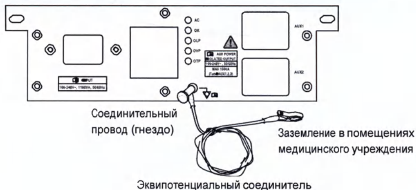
[Рис. 1.1 Эквипотенциальное заземление]
