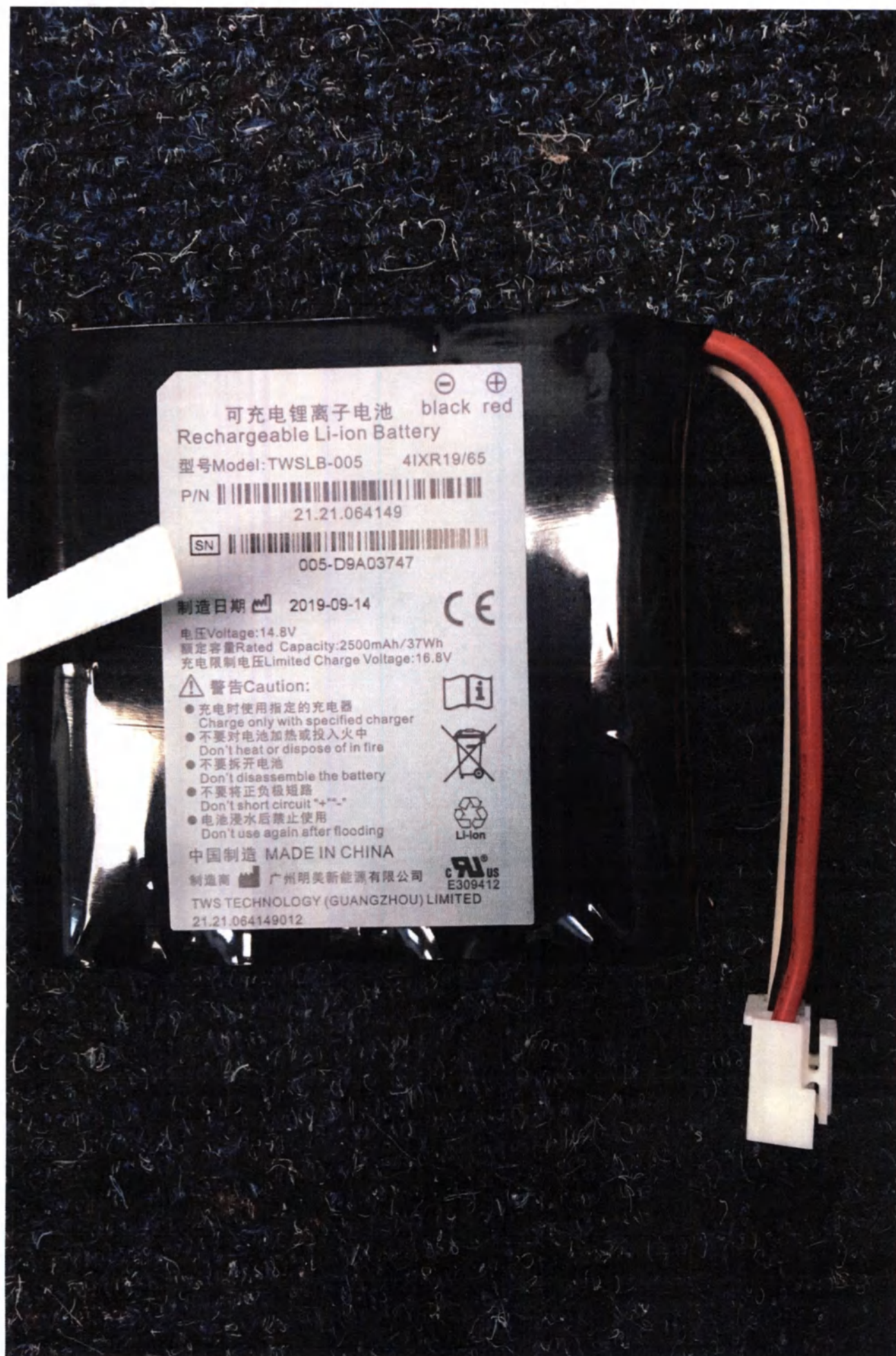
Рис. 6 Батарея перезаряжаемая литиевая с кабелем для подключения к блоку основному
