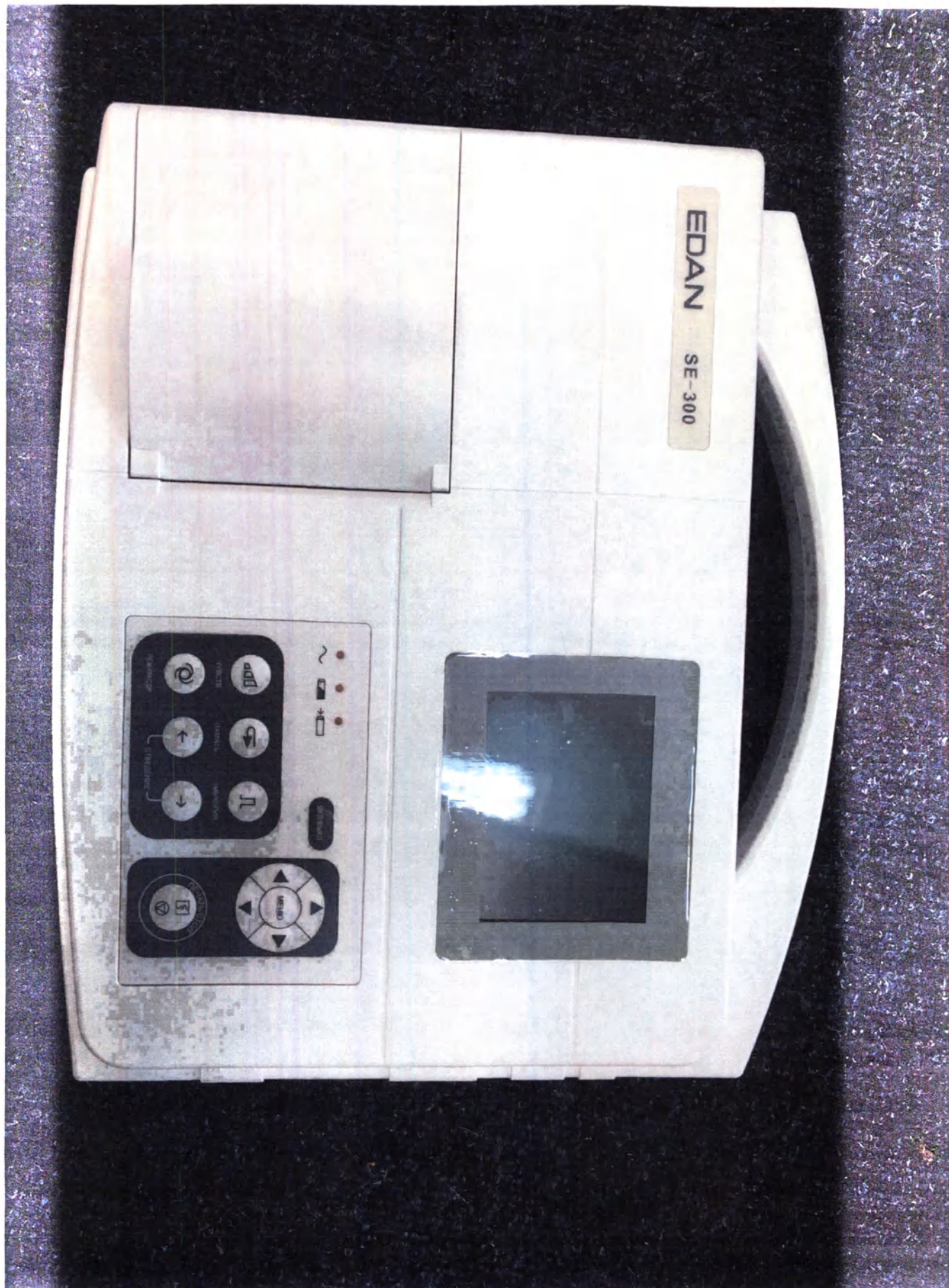
Рис. 3 Блок основной SE-300B (блок основной SE-300A имеет аналогичный внешний вид: на маркировке в левом углу указана общая серия изделий SE-300, конкретная модель указана на основной маркировке на задней стороне корпуса; оба варианта исполнения имеют одинаковый внешний вид, за исключением отображения данных на дисплее: SE-300A оборудован черно-белым экраном, а SE-300B – цветным)
