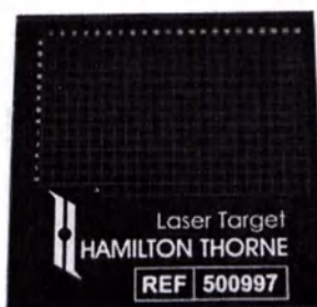
Иллюстрация 2-10: Слайд для настройки прицеливания лазера (Laser Target Slide)
