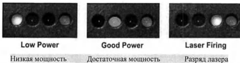
Иллюстрация 3-4: Светодиодная индикация состояния контроллера лазера
