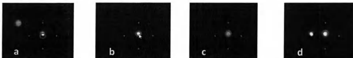
Иллюстрация 6-3: Выравнивание указателя RED-i по пятну лазерного пучка
