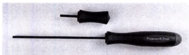
Иллюстрация 2-4: Отвертка шестигранная 1.5 мм, длинная, для регулировки RED-i; Отвертка шестигранная 1.5 мм, короткая, для регулировки RED-i;
