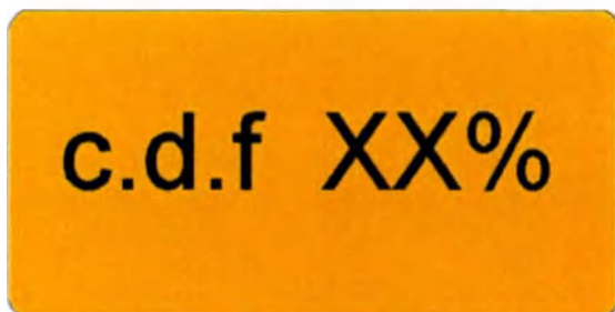
(7) Табличка с указанием рабочего цикла Коэффициент продолжительности цикла (c.d.f— cyclic duration factor) определяет отношение максимального времени работы к общему времени работы системы.
