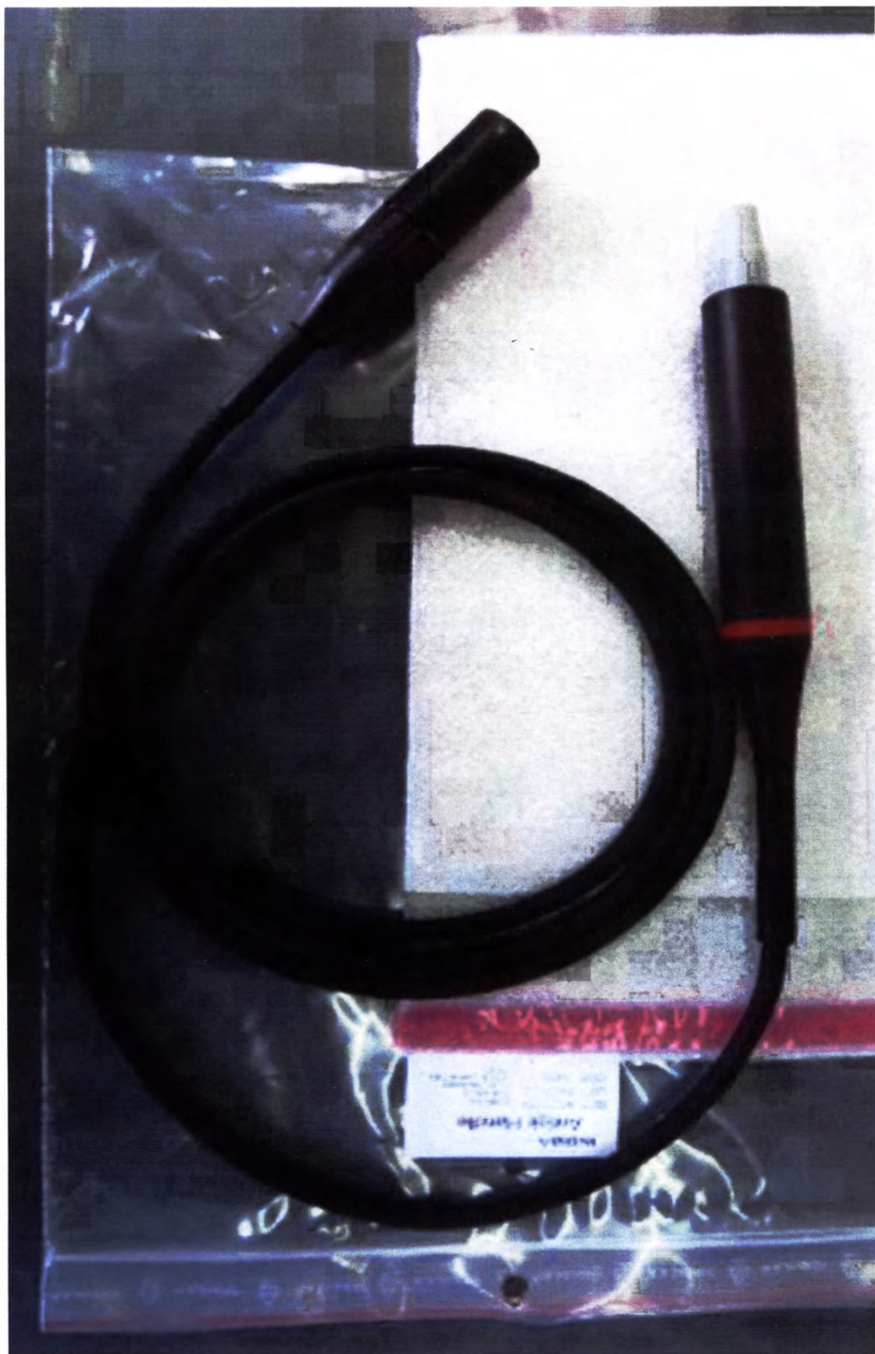
Рис. 4 Рукоятка с ограничением углового перемещения электрода
