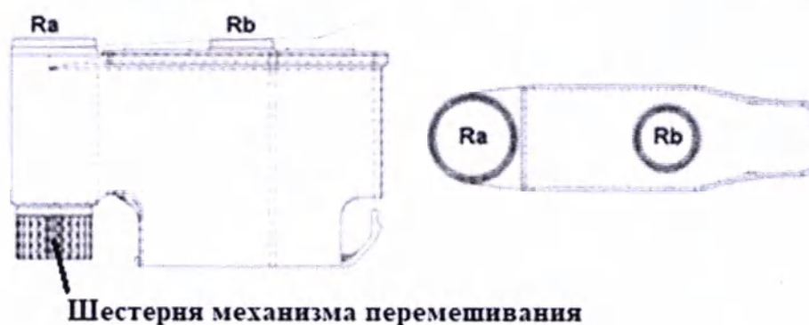
Рис. 4.1 Расположение реагентов в кассете
