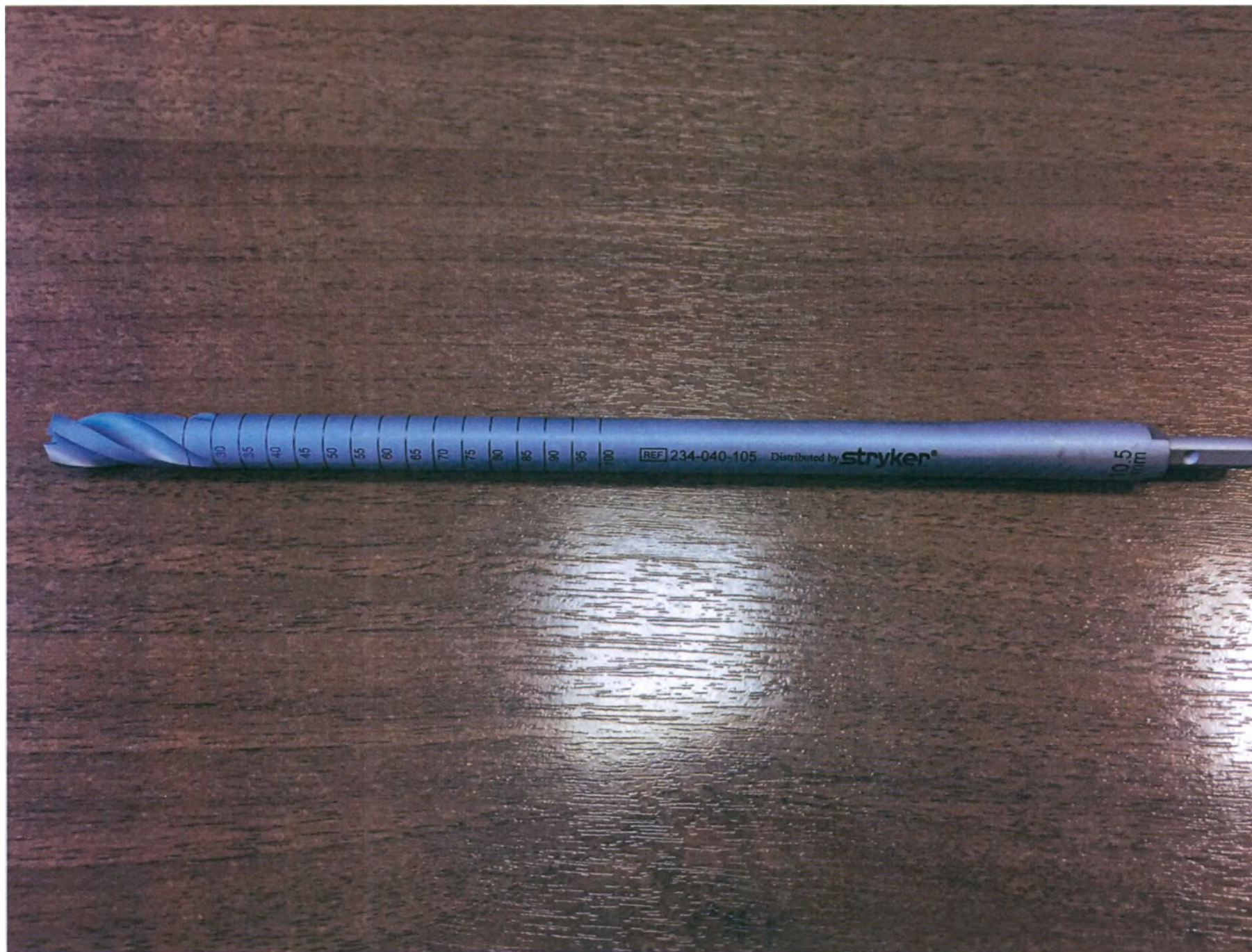
Сверло канюлированное VersiTomic 10,5 мм
