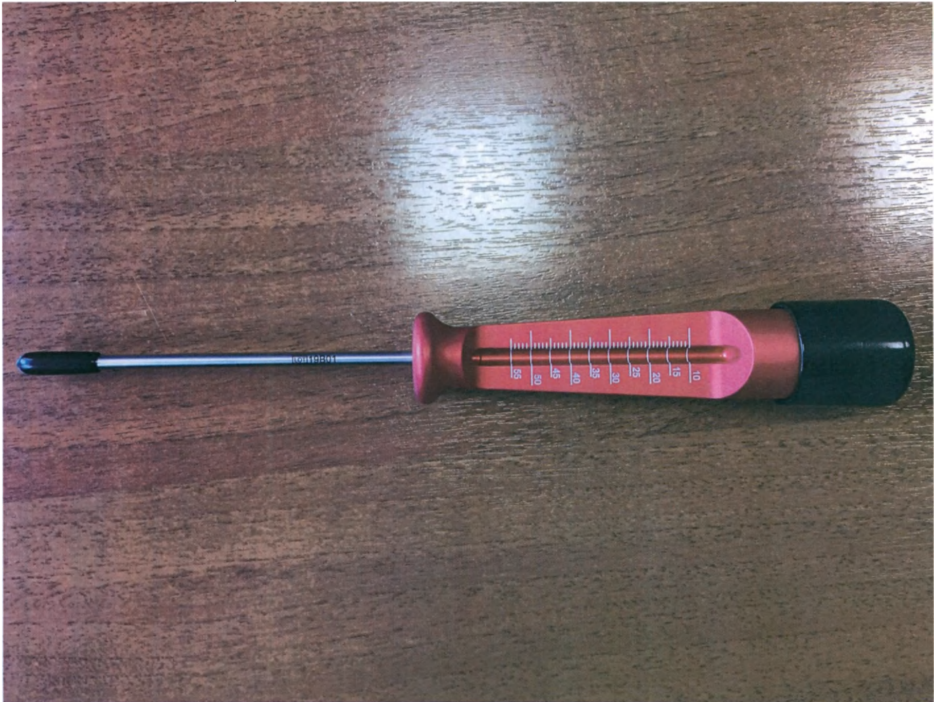
Измеритель глубины "снаружи внутрь"
