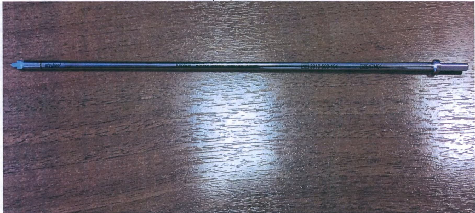
Сверло пробное 3.5 мм
