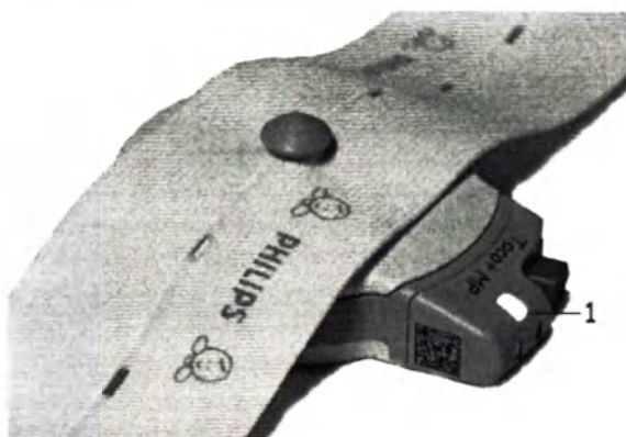
1 СИД обнаружения на бескабельном датчике
