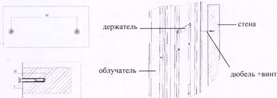
Рисунок 4 – Схема крепления облучателя на стену.
