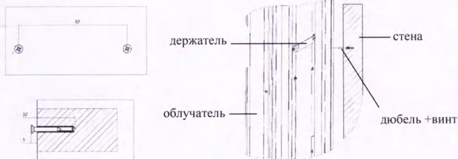
Рисунок 4 – Схема крепления облучателя на стену.
