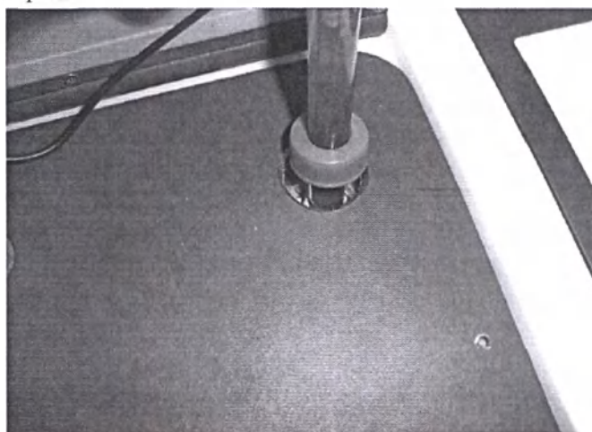
Датчик помещен в питательную среду через порт в крышке камеры.
