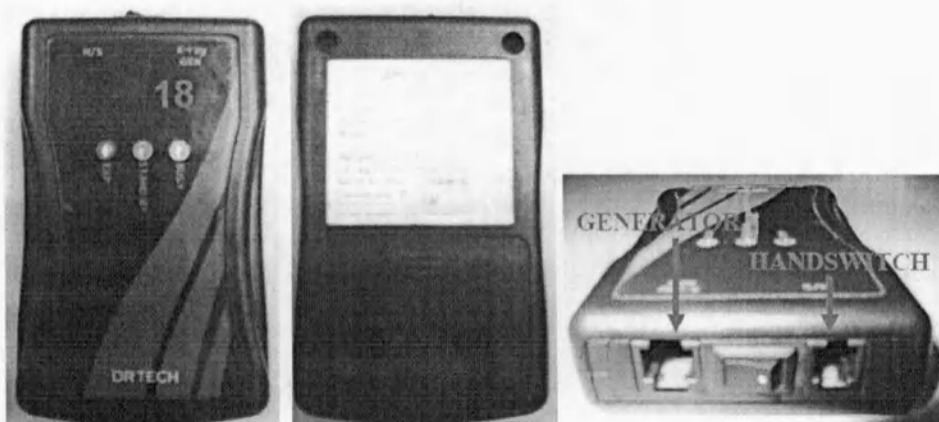
18. Плата переключателя беспроводного детектора DRTech и ее размещение на генераторе.
