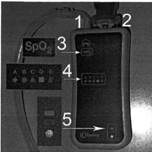
Рис. 36: Беспроводной аккумуляторный модуль RPU. 1. Разъем дыхательного пояса. 2. Разъем модуля RPU. 3. Индикатор типа устройства: ВКГ или SpO 2 (в случае RPU). 4. Индикатор используемой в данный момент сети. 5. Индикатор состояния аккумулятора
