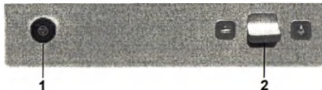
Рис. 4: Кнопка аварийной остановки стола (1) и кнопка возобновления (2) (тумблер служит для возобновления перемещений деки стола).
