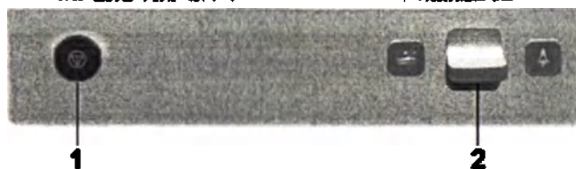
Рис. 23: Кнопка аварийной остановки стола (1) и кнопка возобновления (2) (тумблер служит для возобновления перемещений деки стола).
