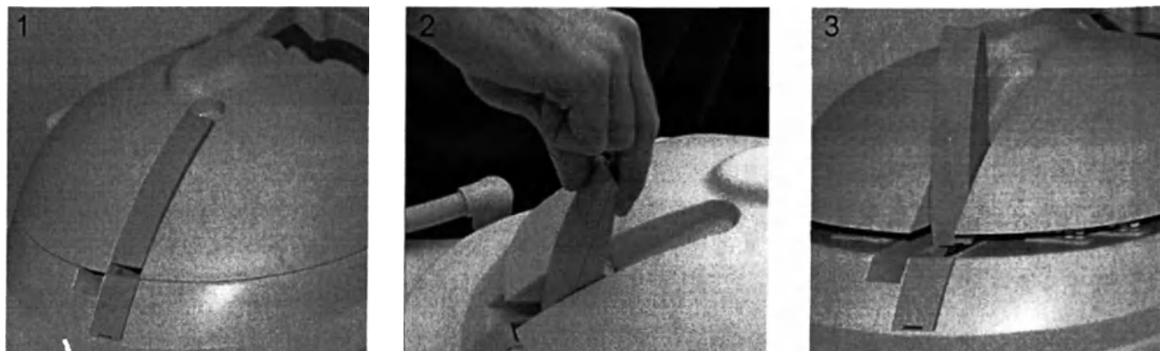
Рис. 119: 1. Передняя часть катушки, прикрепленная к задней части. 2. Отстегивание передней части с помощью отведения рукоятки. 3: Передняя часть отстегнута.
