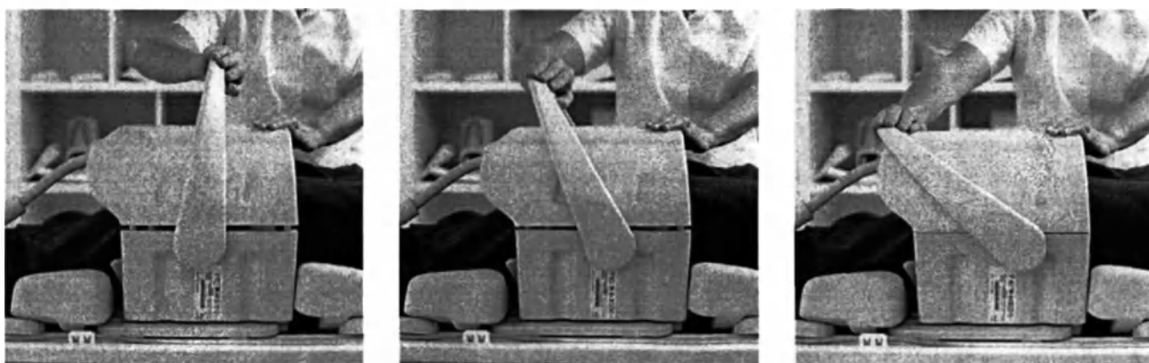
Рис. 187: Закрывание 16-канальной катушки для dS Knee при помощи U-образного затвора.
