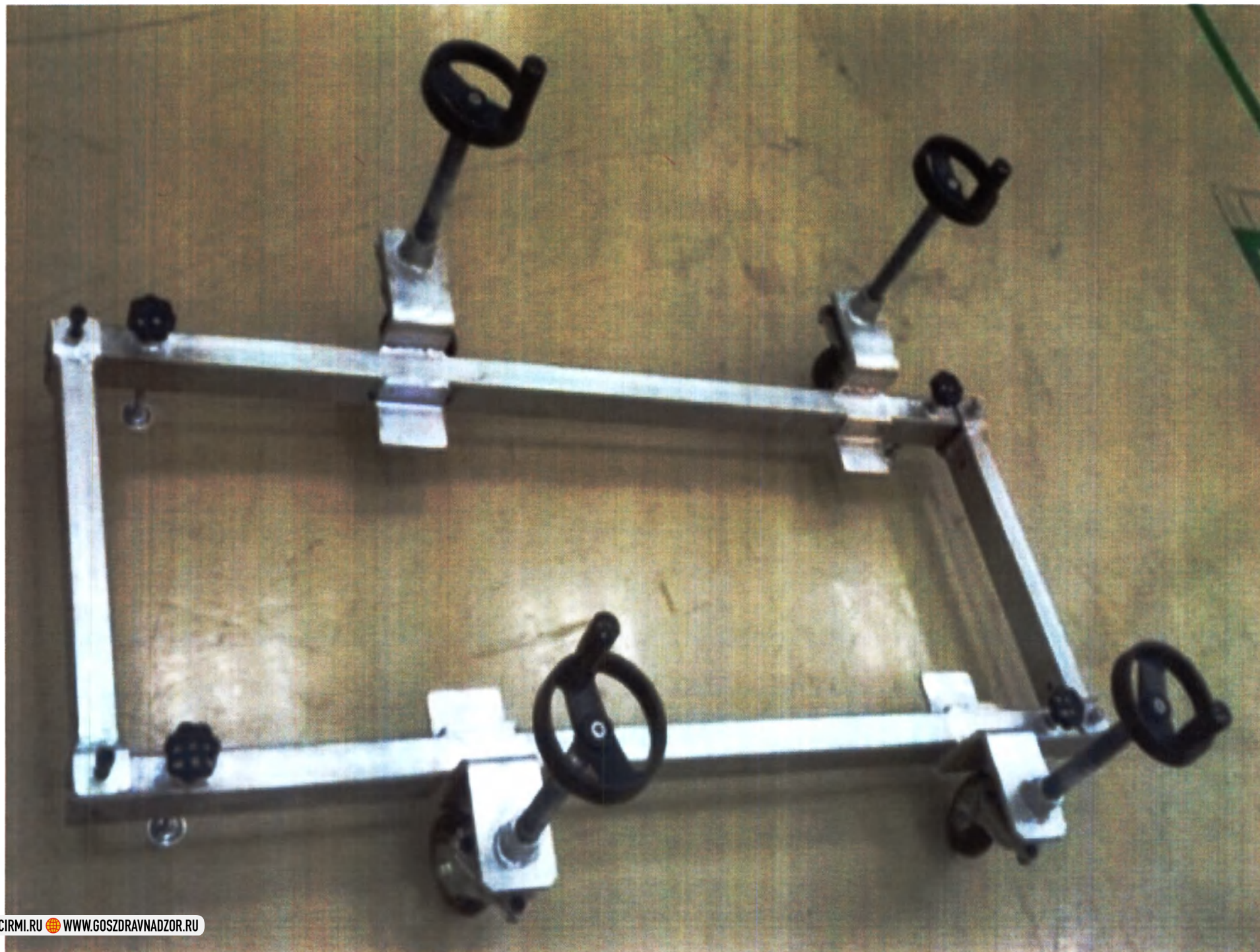
58. Транспортные приспособления для позиционирования и монтажа (не более 30 штук).
