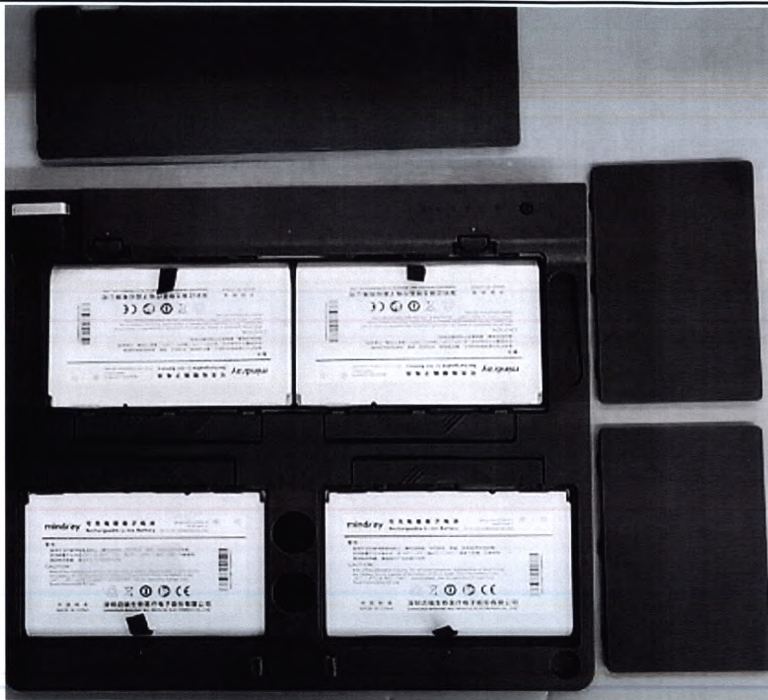
Комплект из четыре х аккумуляторов встраиваемых (U-Bank). Вид с открытыми отсеками для аккумуляторов
