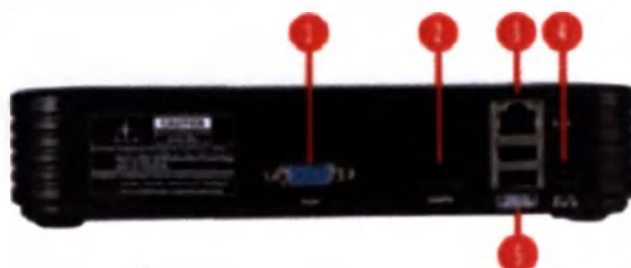
Рис. 1 – Видеорегистратор (1 – Выход VGA; 2 – Выход HDMI; 3 – Сеть; 4 – Питание; 5 – USB)
