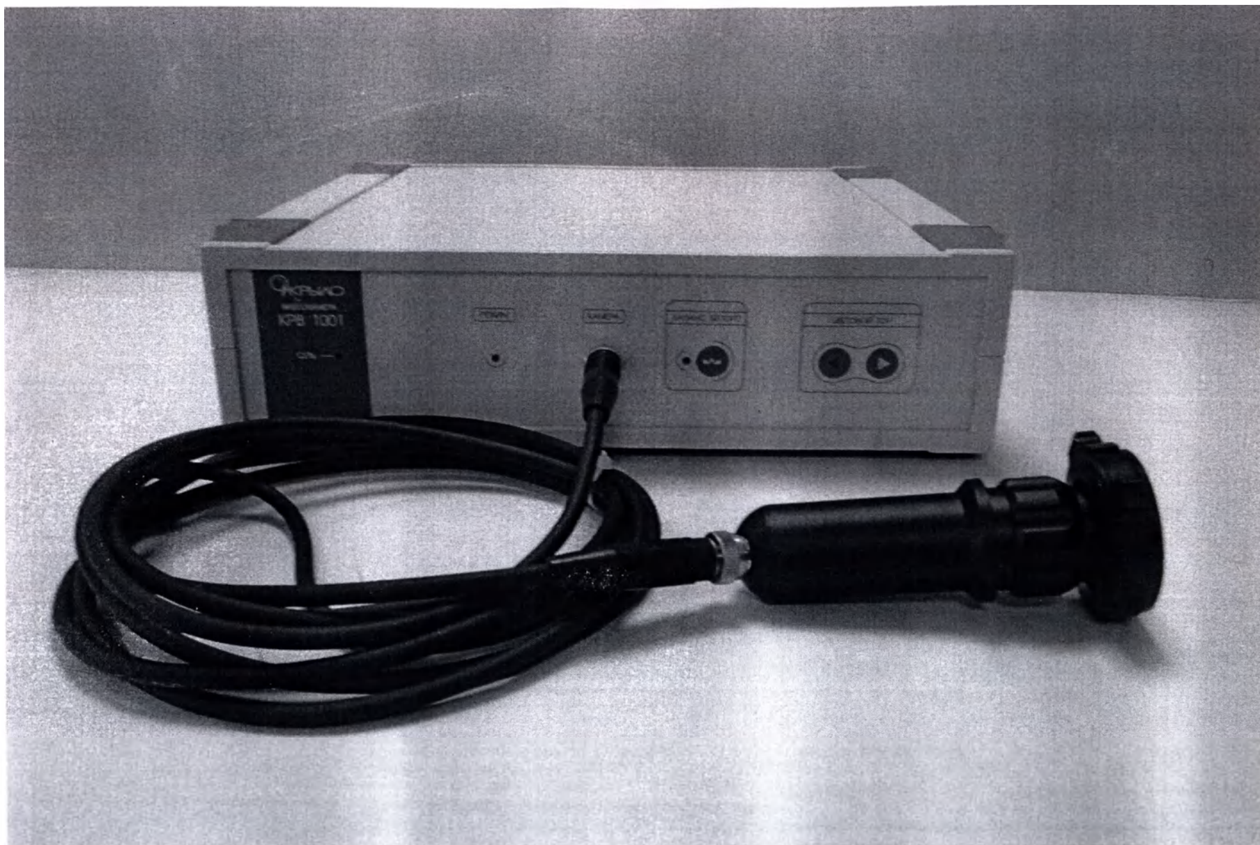
Видеокамера для формирования телевизионного сигнала цветного изображения от медицинских эндоскопов ВК – 01 – «КРЫЛО» Тип1 КРВ 1001
