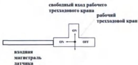
Рис. 6.4.2-5 Положение регулятора рабочего трехходового крана после окончания заполнения магистрали датчика .
