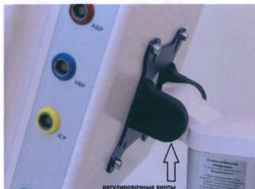
Рис. 6.2-2 Регулировка угла положения моноблока прибора на мобильной стойке
