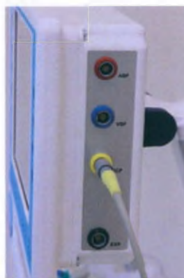
Рис.6.2-4 Кабель датчика ICP «желтый» подсоединен к разъему моноблока «ICP» желтый
