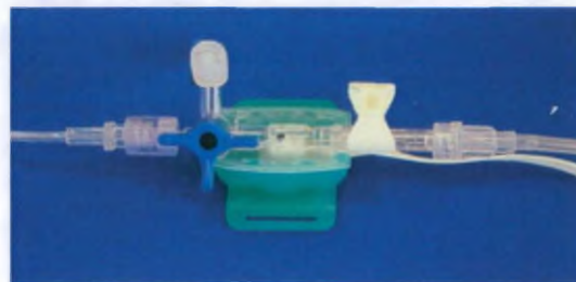
Рис. 6.4.4.1-5 Схема и вид положения 2 входного трехходового кран датчика после окончания калибровки
