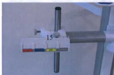
Рис.5.2.1-3 – Внешний вид прибора. Ложемент-держатель датчиков, установленный на вертикальную направляющую мобильной стойки
