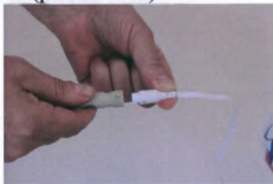
Рис.6.4.3-1 Стыковка разъема датчика с соответствующим разъемом кабеля
