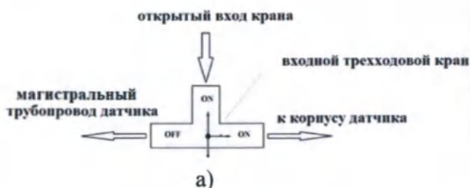
Рис. 6.4.4.1-2 Схема и вид положения 1 входного трехходового крана датчика при калибровке датчика.
