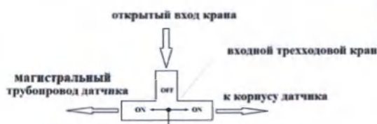
Рис. 6.4.4.1-5 Схема и вид положения 2 входного трехходового кран датчика после окончания калибровки
