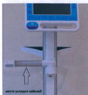
Рис.6.2-3 место укладки кабелей датчиков на мобильной стойке
