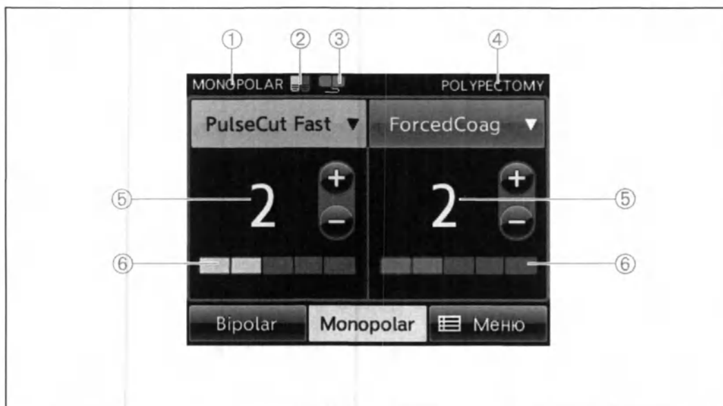
Рисунок 3.8 Индикаторы и дисплеи на начальном экране
