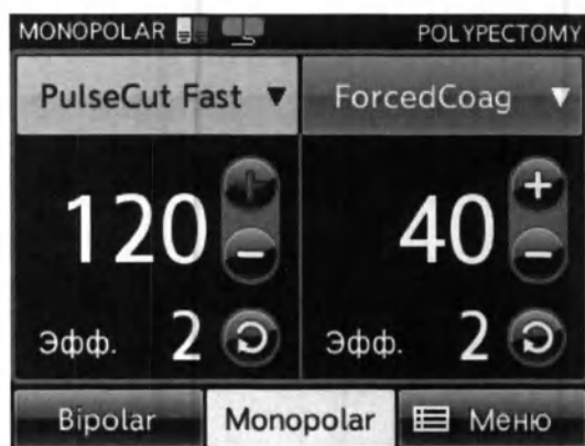
Рисунок 5.1 Уровень опытного пользователя: отдельные кнопки мощности и воздействия
