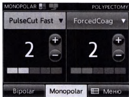
Рисунок 5.2 Уровень обычного пользователя: одна кнопка для уровня комбинированной мощности/воздействия
