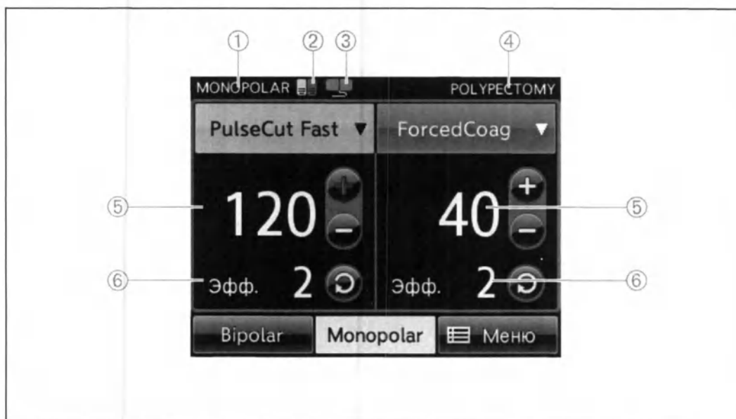
Рисунок 3.6 Индикаторы и дисплеи на начальном экране
