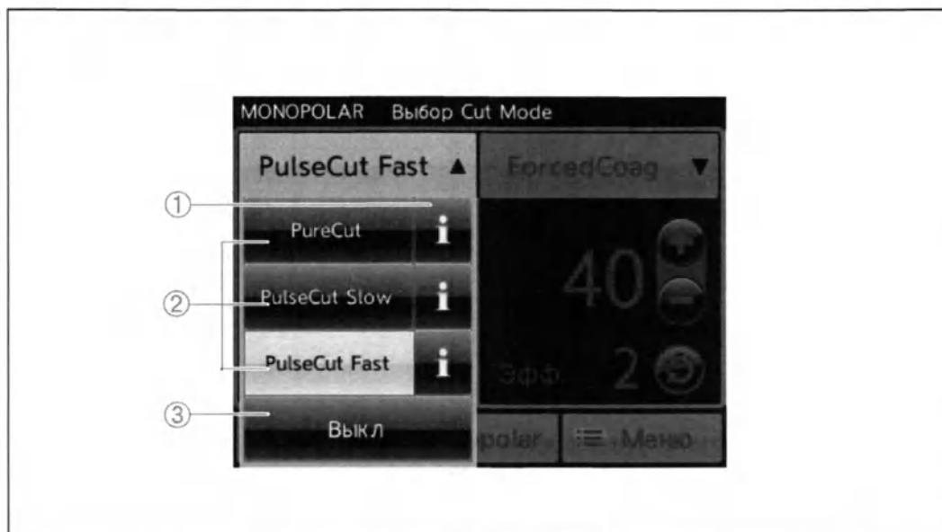
Рисунок 3.9 Раскрывающееся меню [Выбор Cut Mode] для монополярных режимов рассечения
