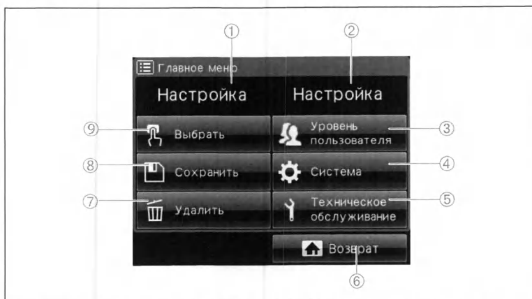
Рисунок 3.10 Редактирование настроек, определяемых пользователем, и системных настроек
