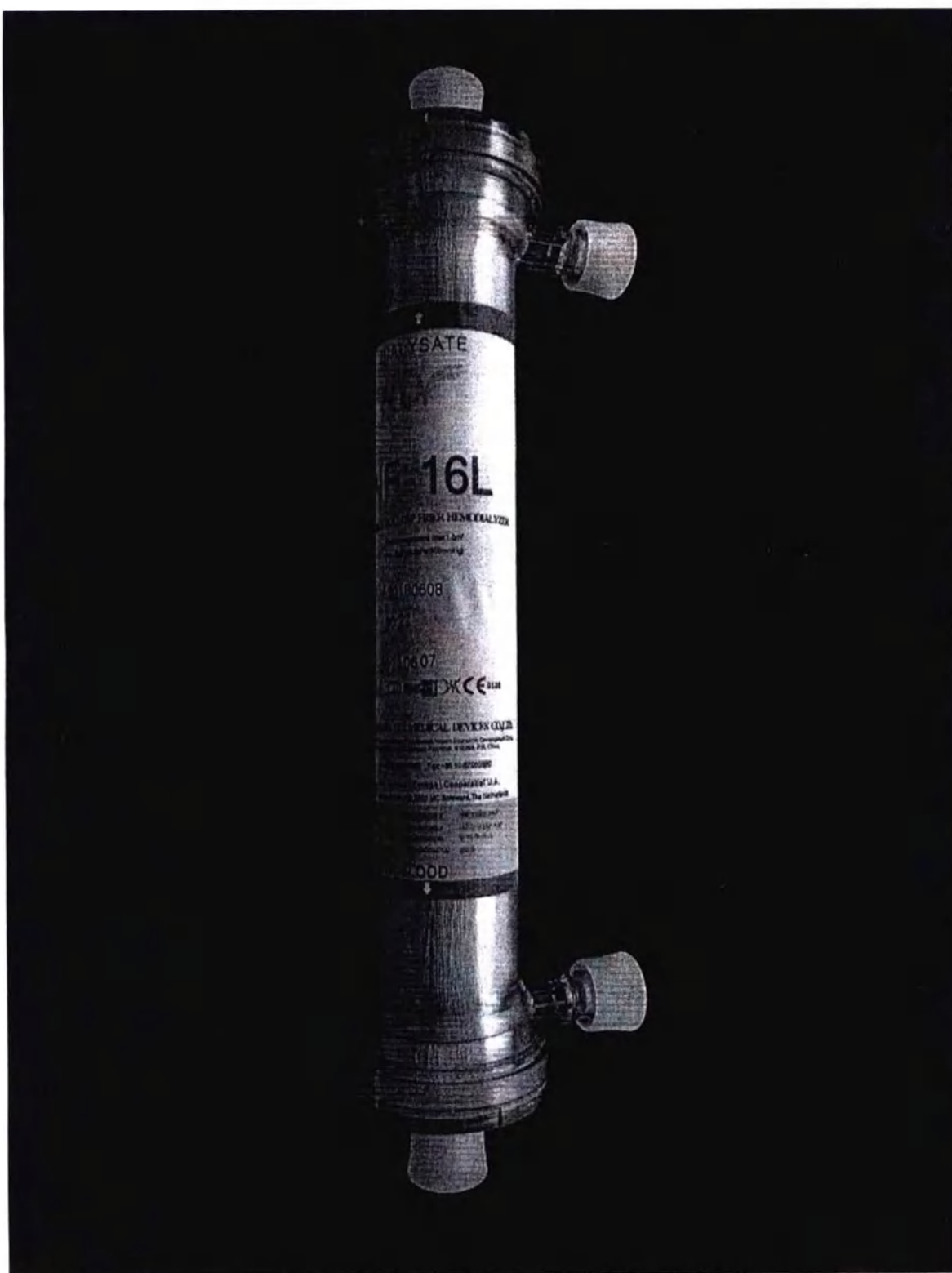
Рисунок 9. Образец 5 – Диализатор капиллярный полиэфирсульфоновый NF низкопоточный NF-16L, LOT 3022, срок годности 2021-06-07. Общий вид
