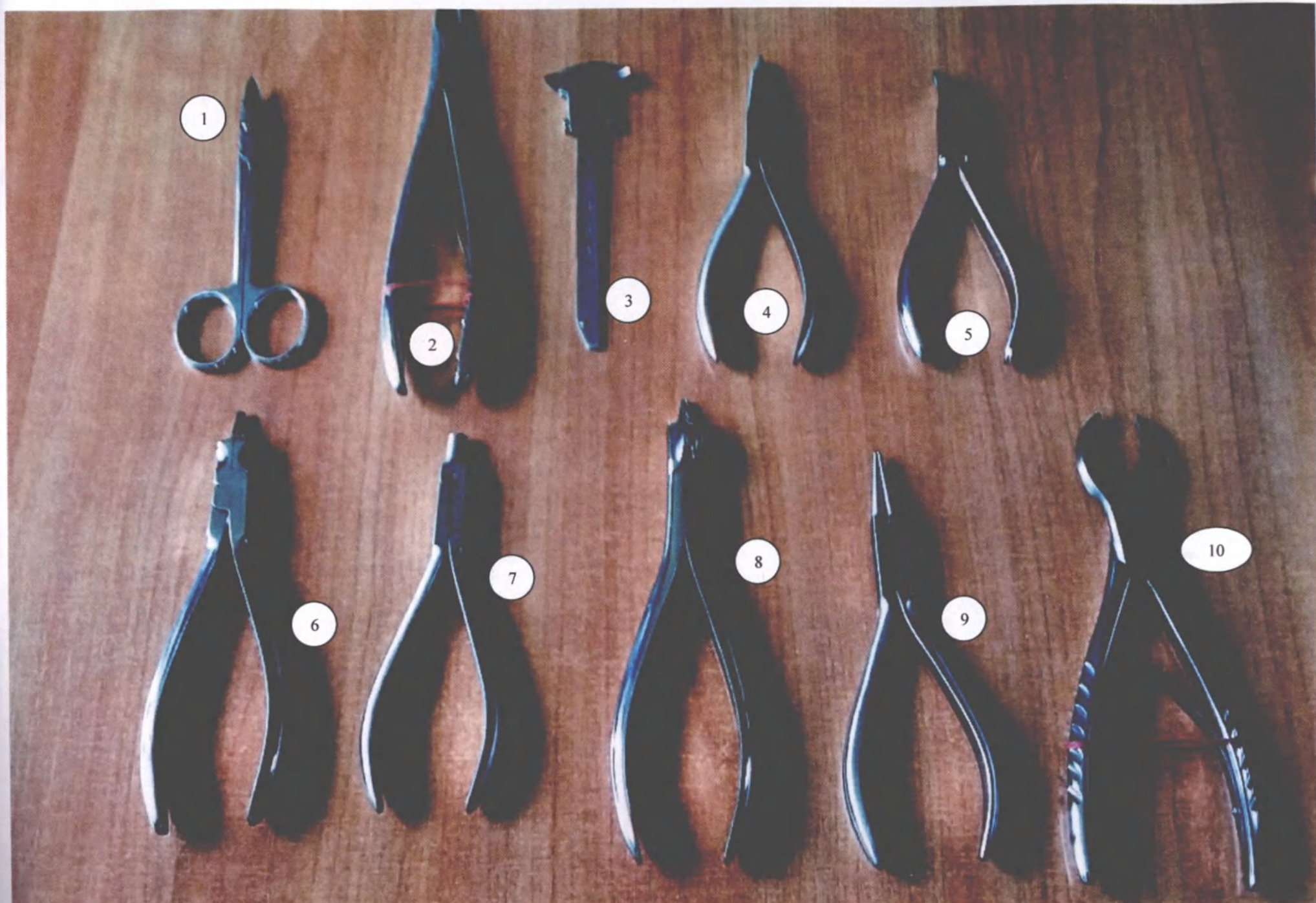
Фото 5. Ножницы для коронок вертикально-изогнутые 125мм 200-1 ТП (1); Ножницы зуботехнические по металлу большие 200-2 ТП (2); Штангенциркуль 1663 ПП (3); Плоскогубцы 2 МП (4); Щипцы клювовидные для коронок 220-1 МП (5); Щипцы краптонные №2 (нержавеющая сталь) 220-2 МП (6); Щипцы ортодонтические (для коронок) 220-3 МП (7); Щипцы круглогубцы зуботехнические для ортодонтии (никелированные) 220-3 МП (8); Щипцы круглогубцы зуботехнические для ортодонтии (никелированные) 220-3 МП (9); Резак 150мм 2247 ПП (10).
