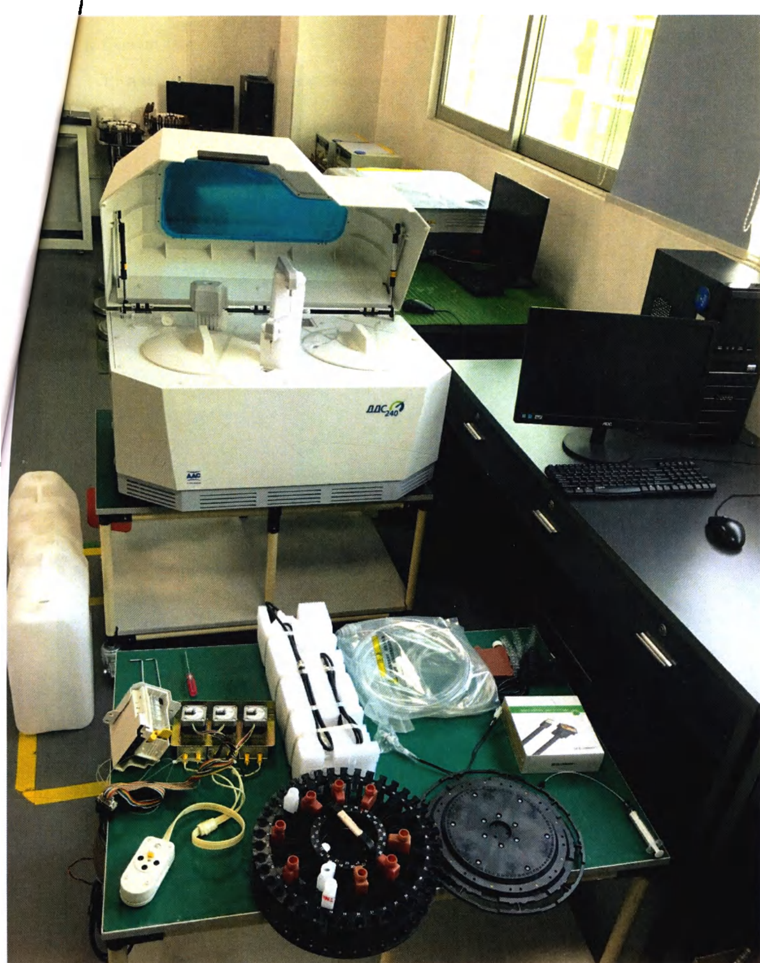
Анализатор автоматический биохимический ДДС-240 с принадлежностями по ТУ ДАЛЕ.941412.002ТУ
