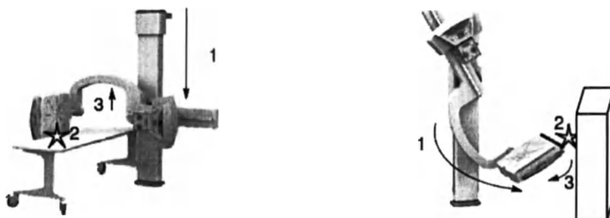
Рисунок 3.24 – Работа датчика столкновения штатива при повороте и движении штатива вниз
