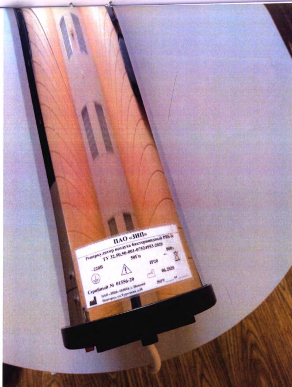
Рисунок 3 – Маркировка рециркулятора воздуха бактерицидного РВБ-36 (слева) и рециркулятора воздуха бактерицидного РВБ-18 (справа) по ТУ 32.50.50-001-07524953-2020.
