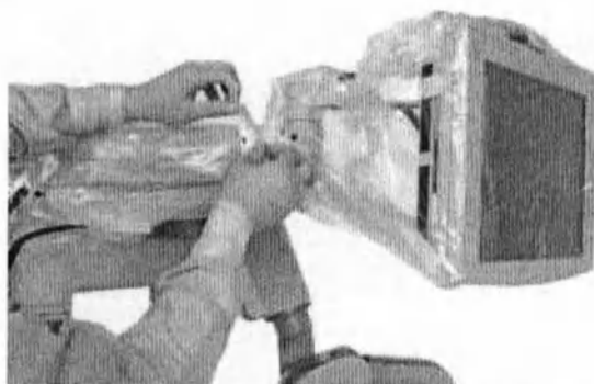
Рисунок 5.12. Оборачивание полос покрытия стойки монитора.
