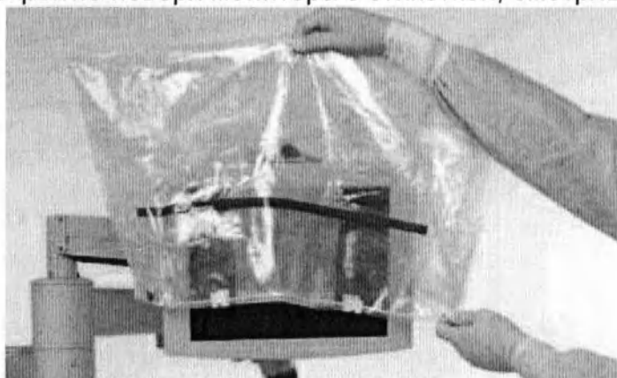
Рисунок 5.8. Опускание покрытия поверх монитора.
