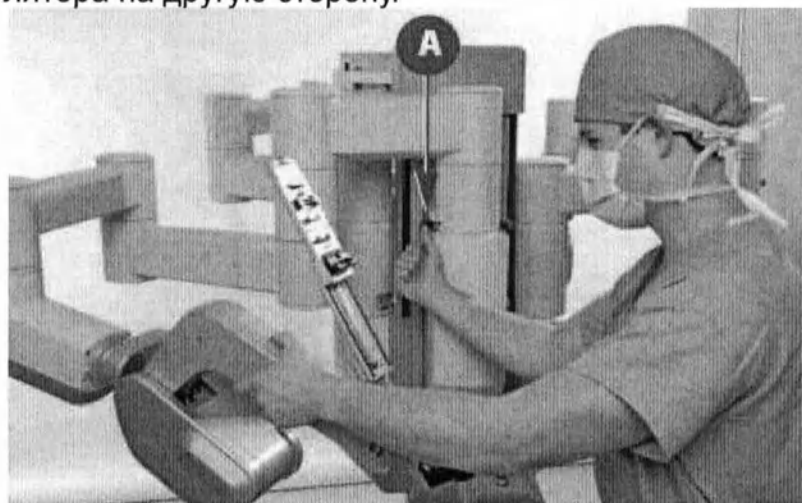
Рисунок 4.6. Перемещение инструментального манипулятора 3.
