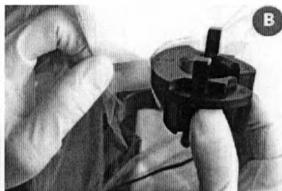
Рисунок 5.16. Снятие бумаги с липкой ленты и присоединение стерильного адаптера манипулятора камеры.
