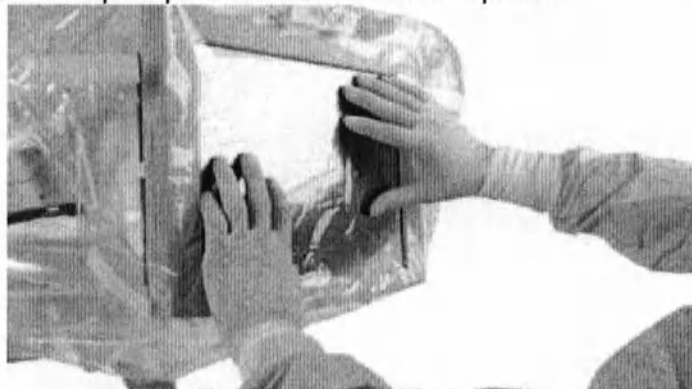
Рисунок 5.10. Разглаживание покрытия на экране.
