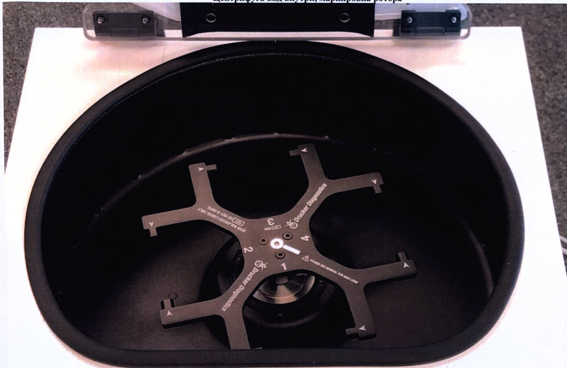
Центрифуга вид внутри, маркировка ротора
