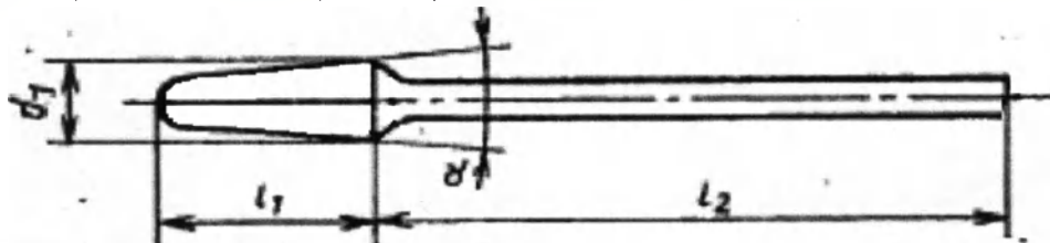
Рисунок № А.8.3. Фреза с прямо-поперечной нарезкой ( d_1 < 2,3 мм).
