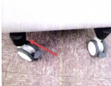
Фотография 2 – блокировочные аппарата колес
