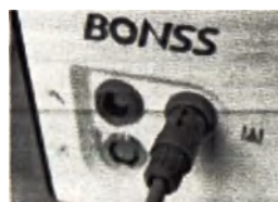
3. Подключите один штекер кабеля к разъему на лицевой стороне контроллера, а другой конец кабеля - к разъему на задней панели блока управления потоком. Убедитесь в правильном направлении подключения кабеля. После успешного соединения включите выключатель питания блока управления потоком.
