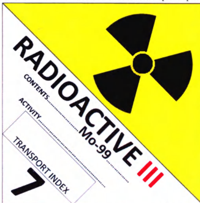
Рисунок 11 – Макет знака опасности для веществ класса 7 транспортной категории III.
