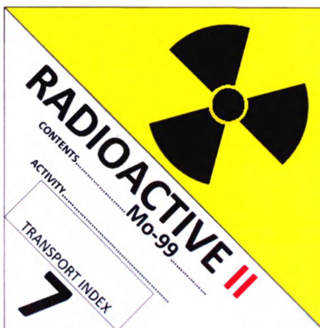
Рисунок 10 – Макет знака опасности для веществ класса 7 транспортной категории II.
