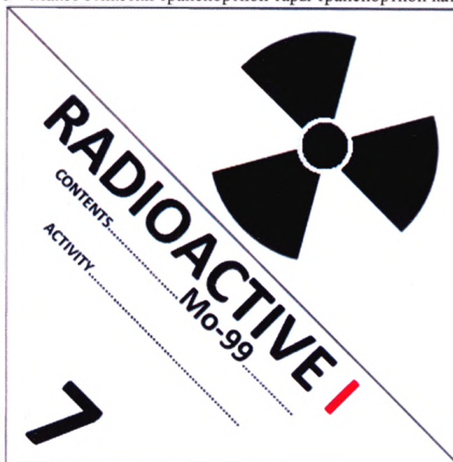
Рисунок 9 – Макет знака опасности для веществ класса 7 транспортной категории I.
