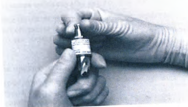
Рис.3. Проверка плавного вращения.
