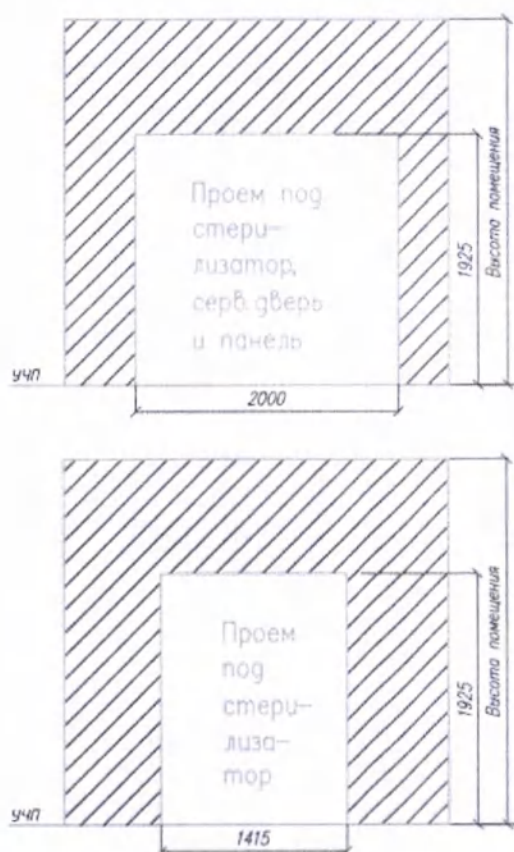
Рис.19. Зона стерилизатора (Сторона загрузки и сторона выгрузки)
