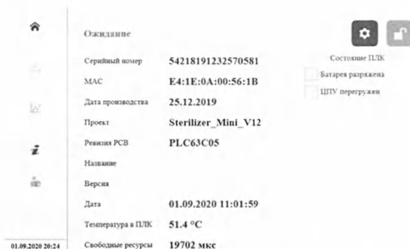
Рис.26. Информация о программируемом логическом контроллере (ПЛК)
