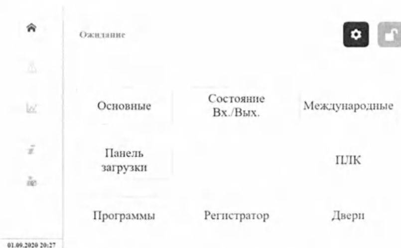
Рис.30. Меню настроек стерилизатора
