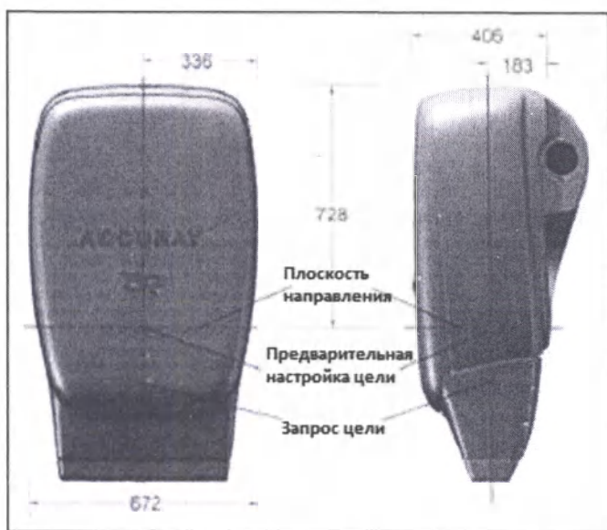
Рисунок 2 Размеры LINAC (мм) от ключевых компонентов, относящихся к экранирующей конструкции.
