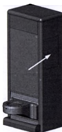
Рис. 20 Отдельный кожух стойки RoboCouch. Кнопка отключения тормоза расположена за дверцей.
