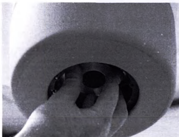
Рис. 6 Установка фиксированного коллиматора вручную
