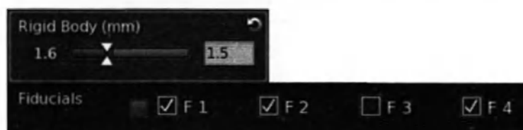
Рис. 12 В этом примере, когда координатная метка 3 исключается из отслеживания, красный кубик отмечает, что координатная метка 1 теперь наиболее причастна к ошибке
