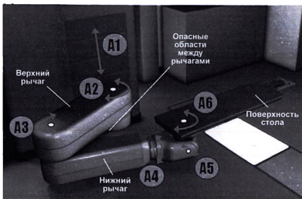
Рис. 19 Компоненты манипулятора RoboCouch и опасные области между рычагами
