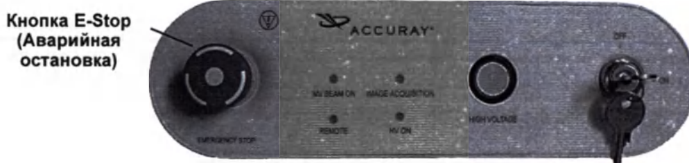
Рис. 2 Кнопка E-Stop (Аварийная остановка) на пульте управления оператора
