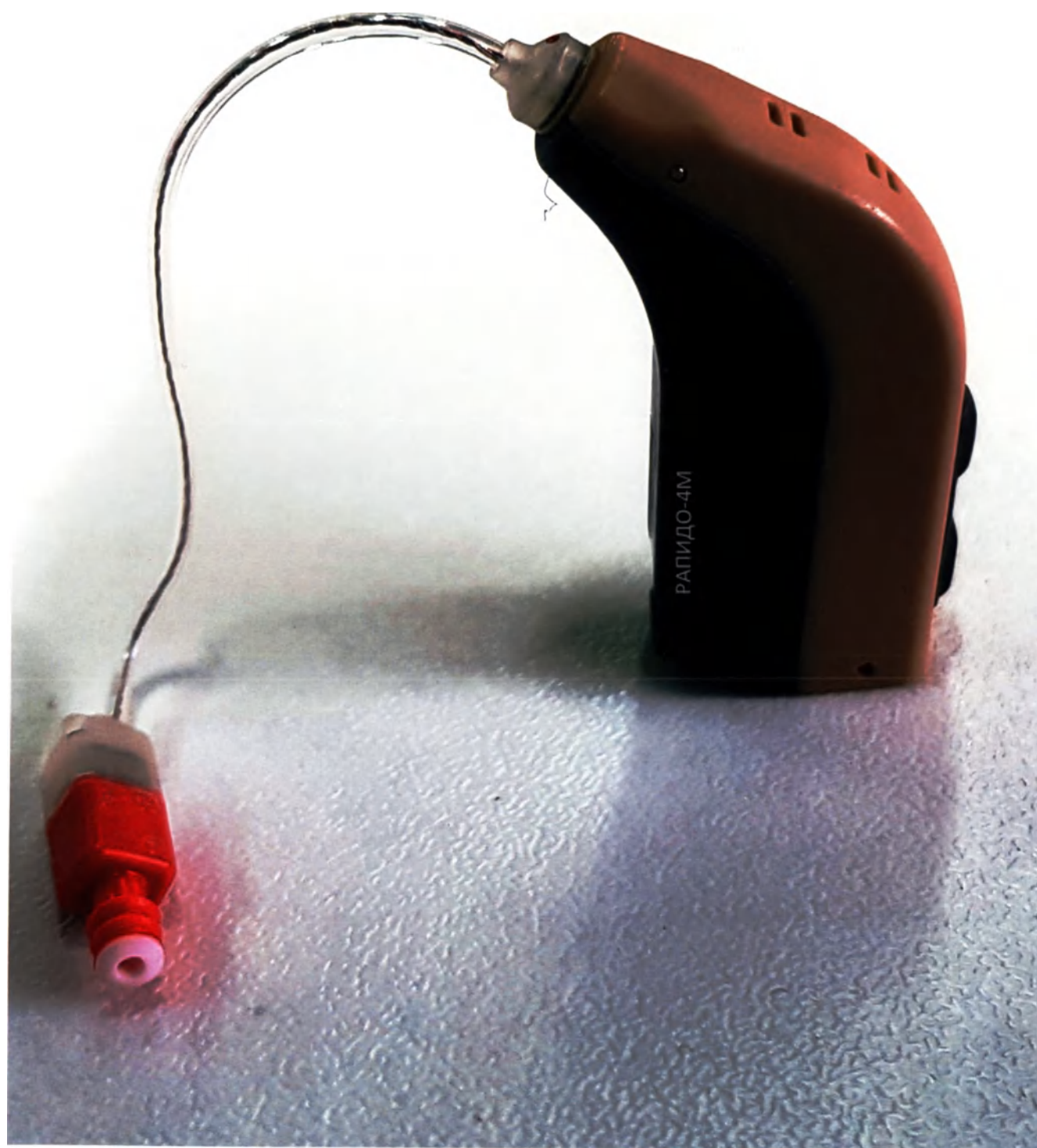
ФОТОГРАФИЯ Аппарата слухового электронного цифрового программируемого воздушного звукопроводения заушного типа с выносным телефоном "РАПИДО-4М".
